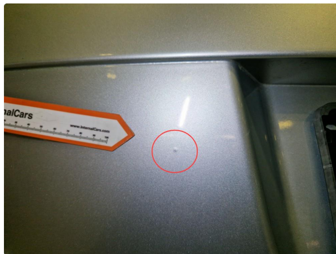
1.4 Flere små rustbobler bakluke.
