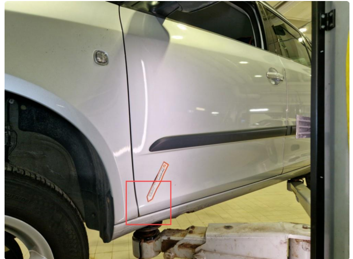
1.2 Flere små rustbobler vframdør, nedre del.
