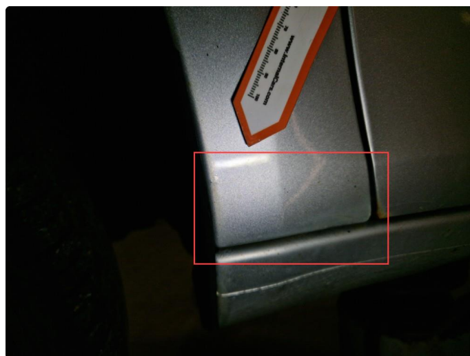
1.5 Rustbobler nedre del v-framskjerm.
