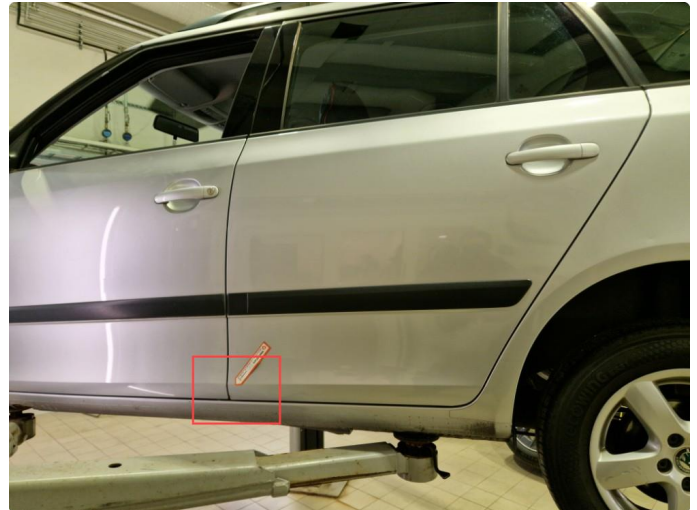
1.3 Flere små rustbobler v-bakdør, nedre del.
