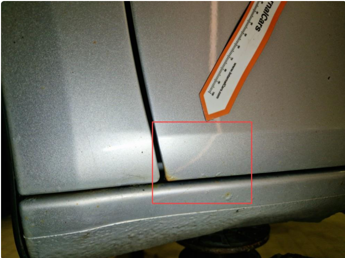
1.2 Flere små rustbobler vframdør, nedre del.
