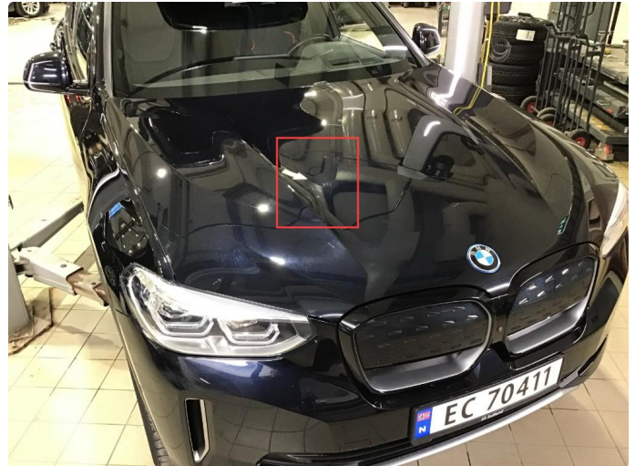
1.1 Noe riper panser ( Poleres )
