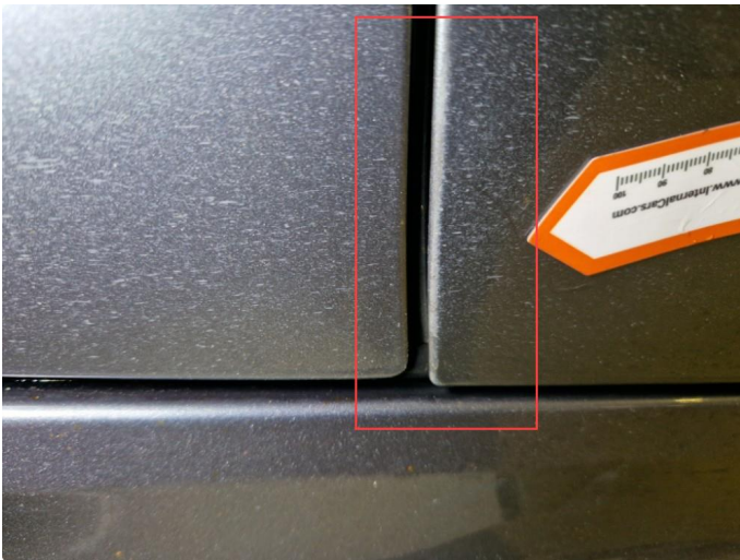
1.3 Flere små rustbobler nedre del v-bakdør , normal bruksslitasje iht. km og alder.
