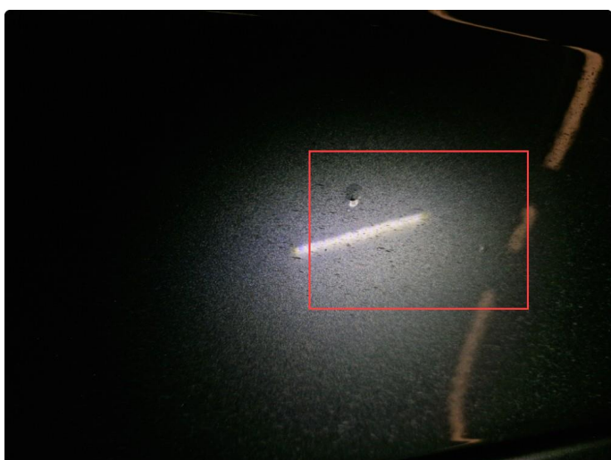
1.4 Flere små rustbobler nedre del h-framdør , normal bruksslitasje iht. km og alder.
