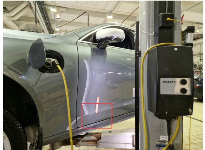
1.2 Flere små rustbobler nedre del v-ramdør , normal bruksslitasje iht. km og alder.
