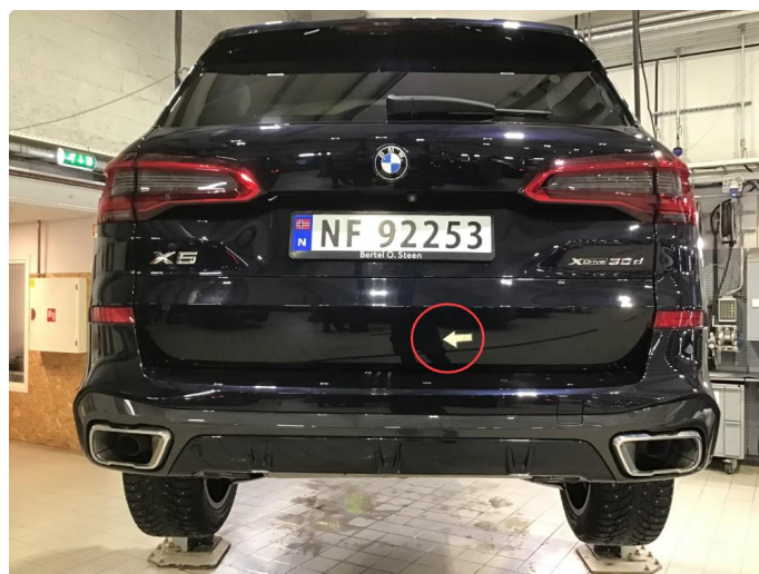
1.3 Liten bulk bakluke, regnes som normal bruksslitasje.
