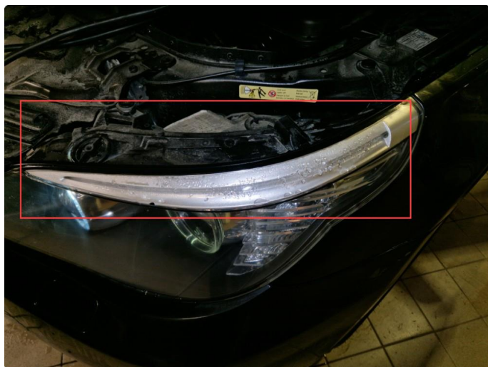
4.1 Fukt hovedlykt h+v side fram.
