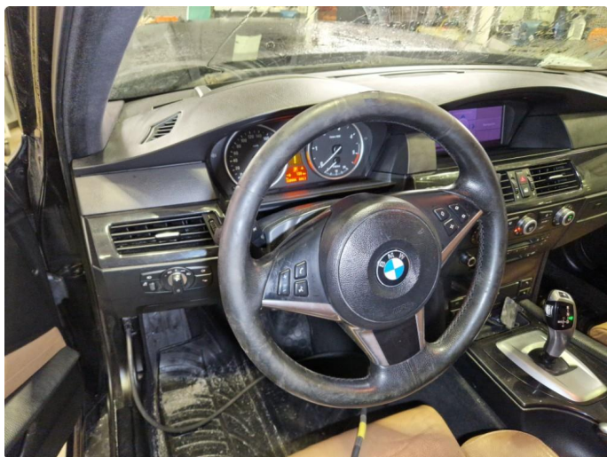
9.2 Slitasje skinntrekk ratt.
