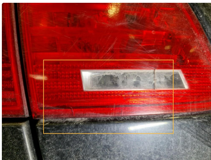
4.2 Sprekkdannelser indre baklykt h+v side.
