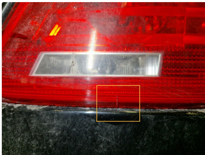
4.2 Sprekkdannelser indre baklykt h+v side.
