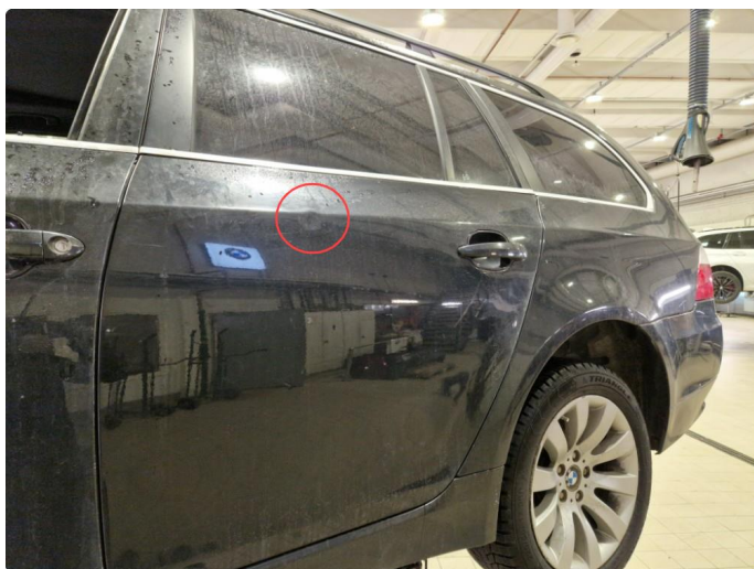
3.3 Bulk øvre del v-bakdør..
