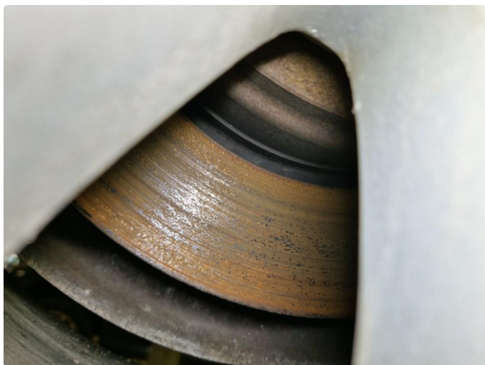
7.3 Rust bremseskiver bak.
