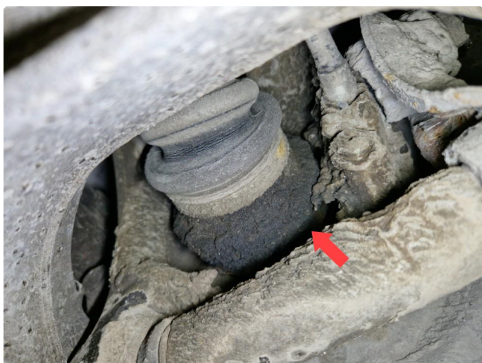
8.2 Ekkasje drivakselmansjett ytre v -bak.
