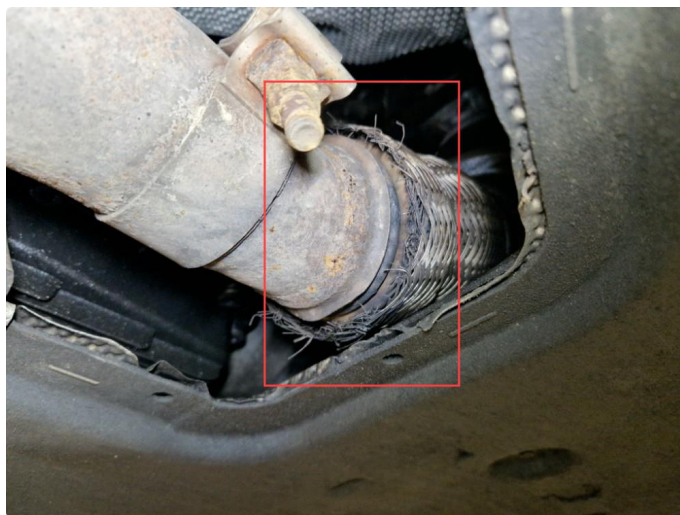
5.1 Slitt / løs flexikobling.
