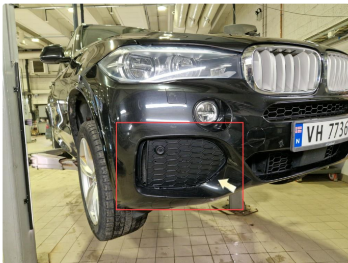
2.12 Lakkskader nedre del h-side frontfanger + løst deksel h-side.
