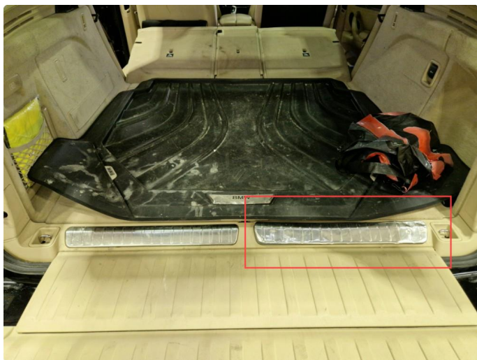
2.6 Skadet innstegslist h-side bagasjerom.
