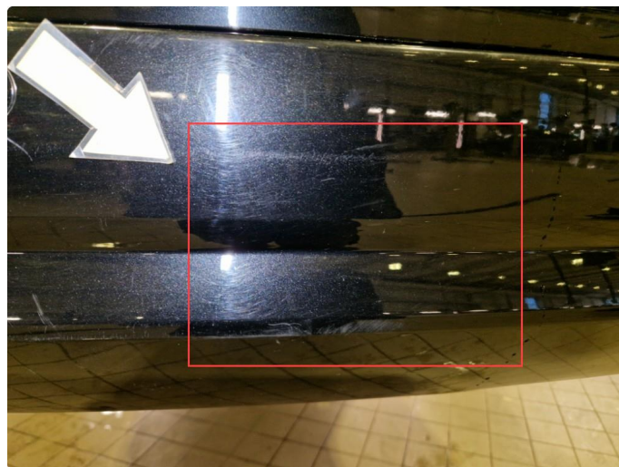
2.13 Lakkskader / knekk i lakk h-side bakfanger.
