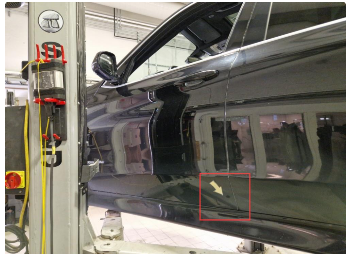
2.2 Rustbobler + p-bulker vframdør.
