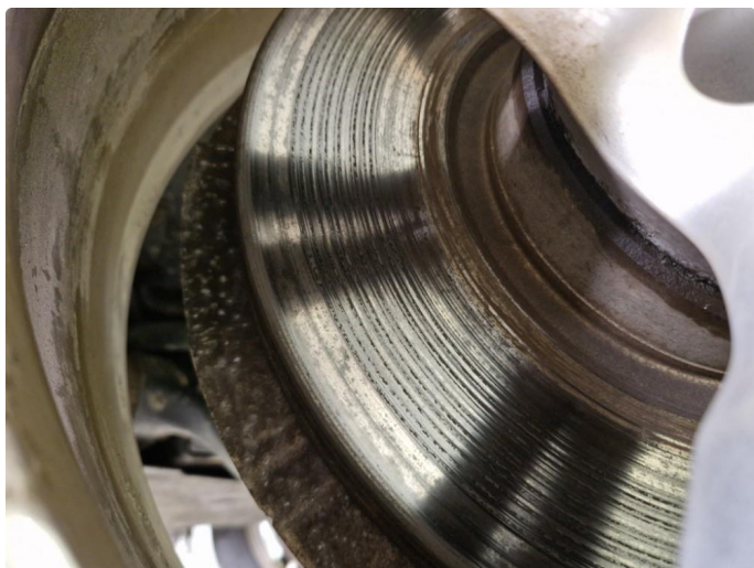
5.1 Slitte bremseskiver fram , bremseklosser målt til 4mm.
