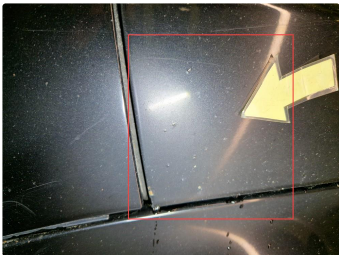
2.2 Rustbobler + p-bulker vframdør.
