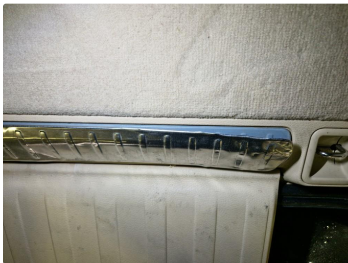
2.6 Skadet innstegslist h-side bagasjerom.
