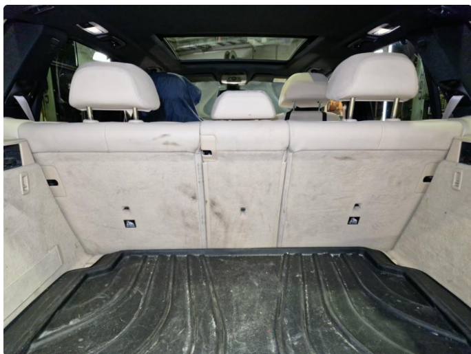
6.3 Misfarget / flekker tepper / bekledning i bil.
