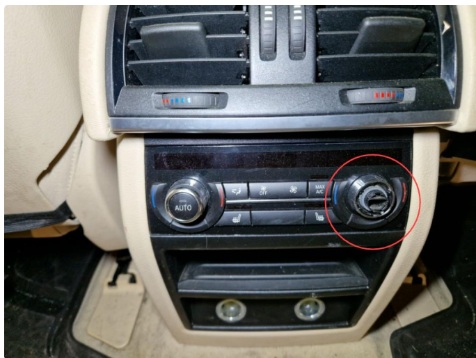
6.1 Mangler knapp klimastyring h-bak.
