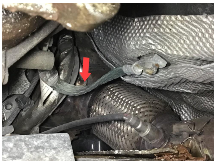
4.5 Irret jordkabel mellom motor og karosseri h-side ved flexikobling.
