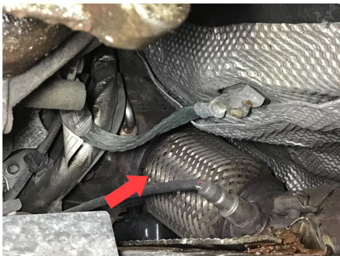
4.1 Defekt flexikobling , løst i framkant.
