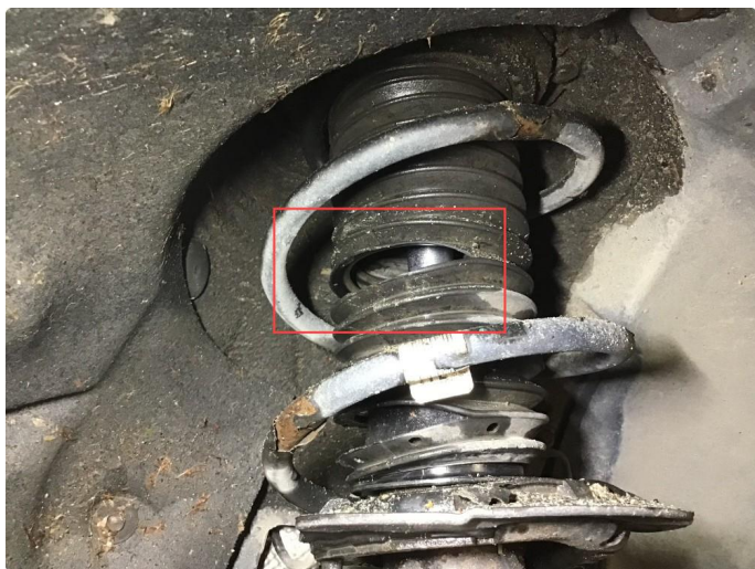
5.1 Sprukket støtdempermansjett h+v fram.
