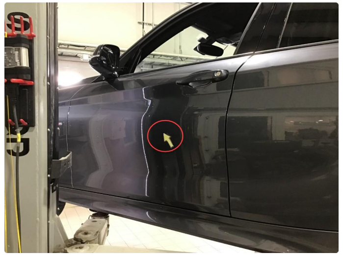
2.2 2 Stk p-bulker v-framdør ( Normal bruksslitasje )
