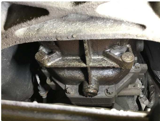
7.1 Lekkasje simring girvelger
