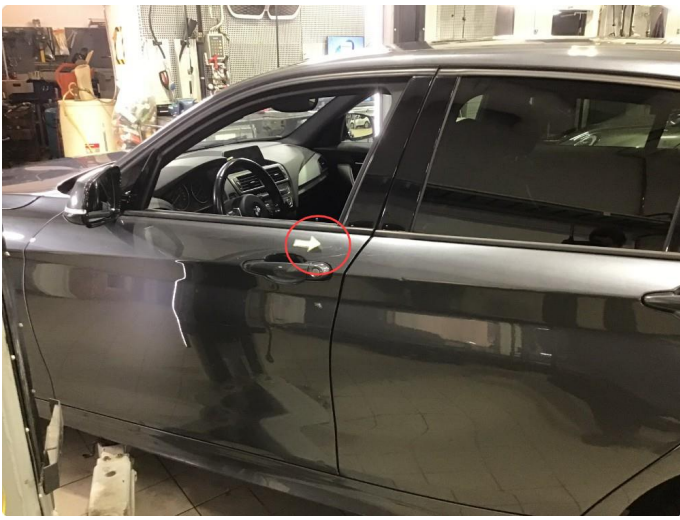
2.2 2 Stk p-bulker v-framdør ( Normal bruksslitasje )
