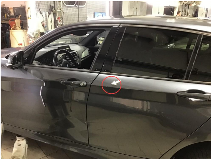
2.3 P-bulk v-bakdør ( Normal bruksslitasje )
