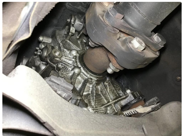
7.1 Lekkasje simring girvelger
