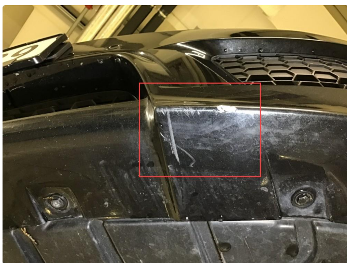
1.5 Skrubbermerker underkant fremfanger, regnes som normal bruksslitasje.
