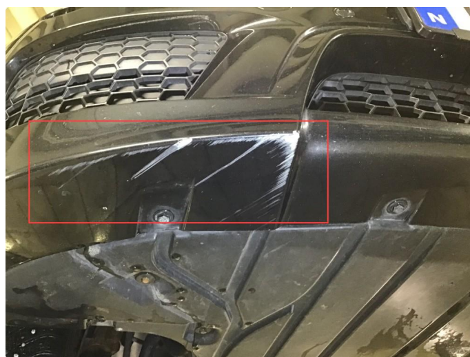
1.5 Skrubbermerker underkant fremfanger, regnes som normal bruksslitasje.
