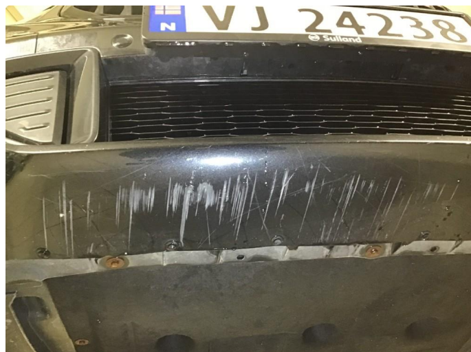
1.1 Noe skrubbermerker underkant fremfanger, regnes som normal bruksliatsje.
