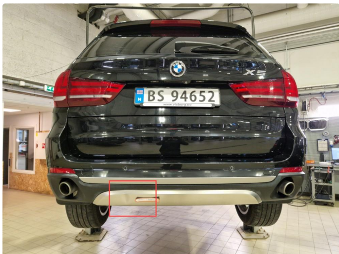
2.8 Skadet / bulk nedre diffusor bakfanger.
