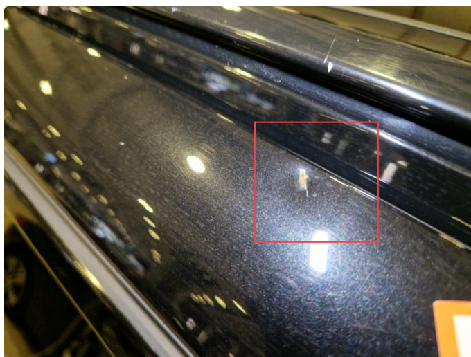
2.10 Bulk med lakksår tak ved rail h-side.
