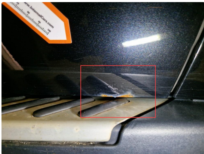
2.2 Rust nedre fremre del hframdør.
