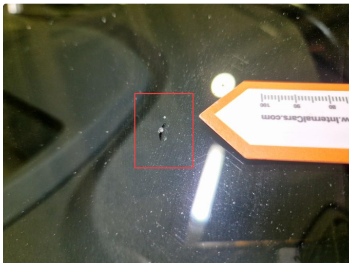
2.11 Lere steinsprut frontrute , rep av 1 stk steinsprut v-side.
