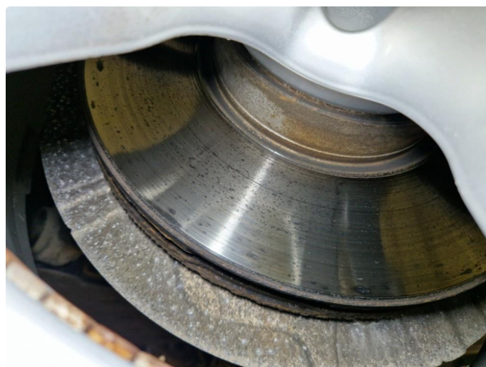
4.1 Pulsering bremseskiver fram , bremseklosser målt til 4,5mm.
