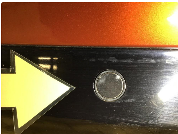
2.1 Korrosjon alle PDC sensorer bakfanger.
