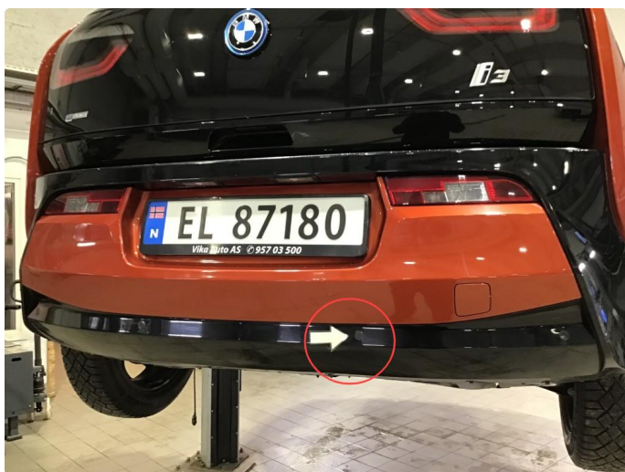
2.1 Korrosjon alle PDC sensorer bakfanger.
