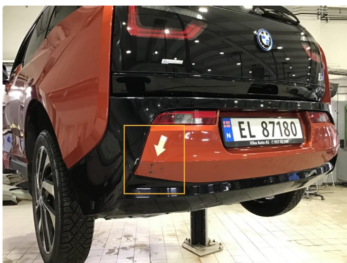
3.7 Lakkskader v-side bakfanger.
