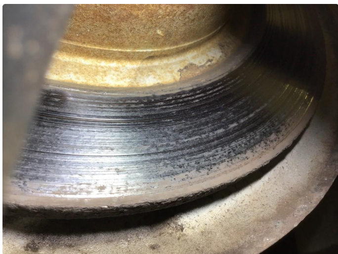
6.1 Rust bremseskiver bak , bremseklosser målt til 10mm.
