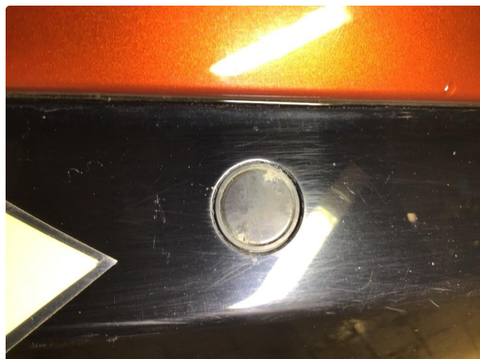
2.1 Korrosjon alle PDC sensorer bakfanger.
