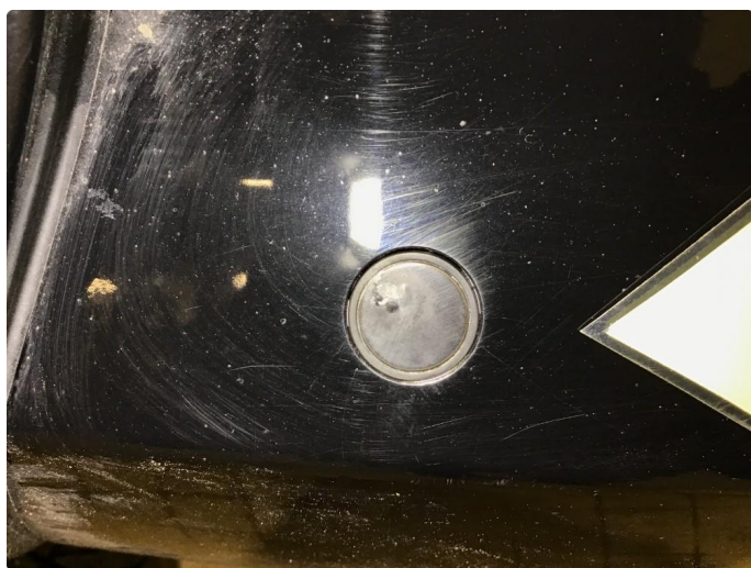
2.1 Korrosjon alle PDC sensorer bakfanger.
