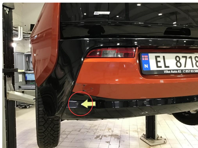
2.1 Korrosjon alle PDC sensorer bakfanger.
