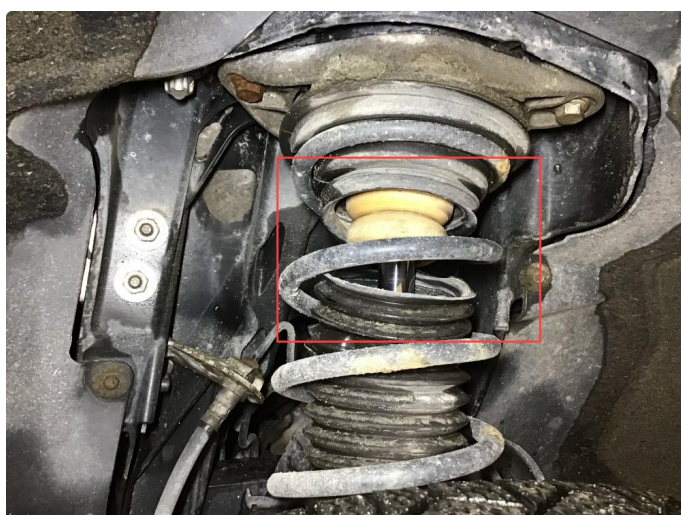
5.2 Støvmansjett defekt. Sprukket støtdempermansjett h+v fram.
