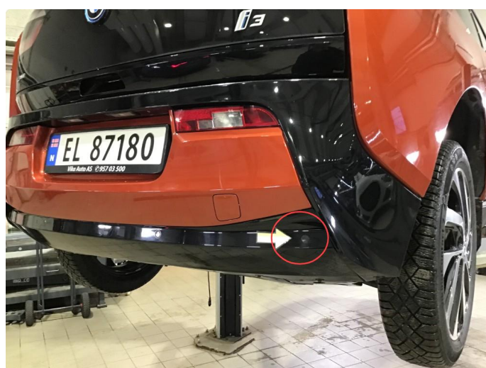
2.1 Korrosjon alle PDC sensorer bakfanger.
