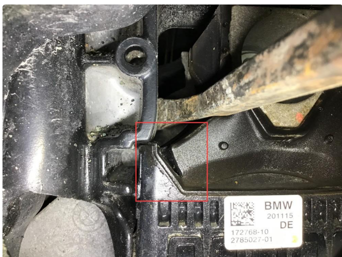
4.1 Defekt motorfeste v-bak , sprukket i framkant.
