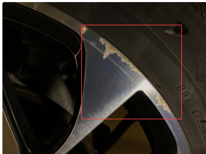
3.3 Noe sår vinterfelg h+v fram + h-bak.
