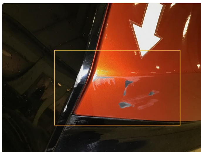
3.7 Lakkskader v-side bakfanger.
