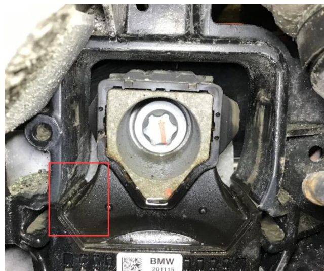
4.1 Defekt motorfeste v-bak , sprukket i framkant.
