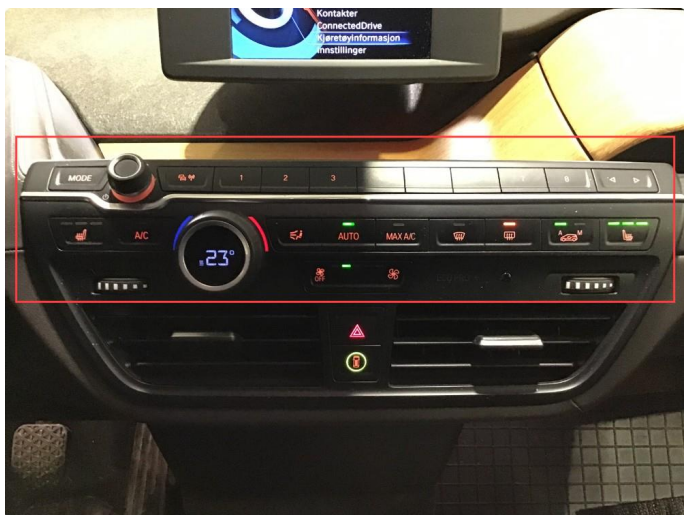
7.1 Bryterbelysning virker ikke. LED indikator for av/på bryter til AC lever sitt eget liv, blinker / skruer seg av og på.
