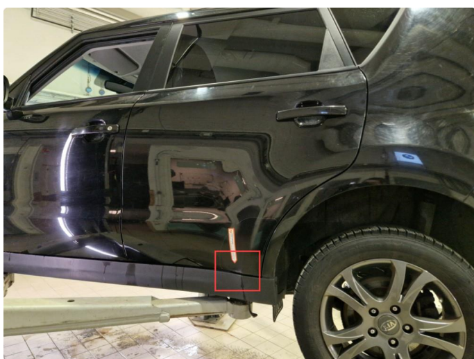
2.4 Rustdannelser nedre del vbakdør.
