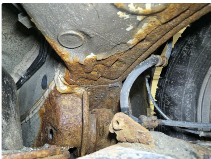
2.1 Rustdannelser underside ved for / bakstilling.
