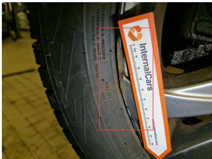
2.12 Bruksmerker vinterfelg v-fram og h-bak.
