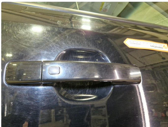
2.6 Rustdannelser + riper / bruksmerker h-framdør.
