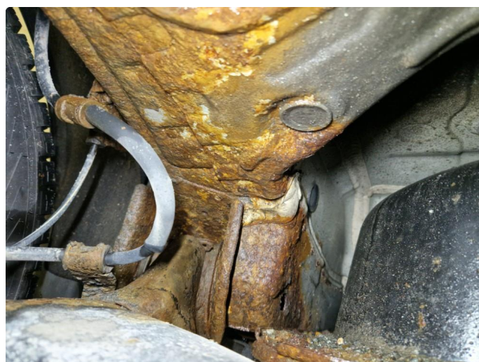
2.1 Rustdannelser underside ved for / bakstilling.
