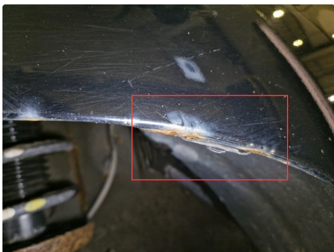
2.8 Stor bulk + rustdannelser v-framskjerm.
