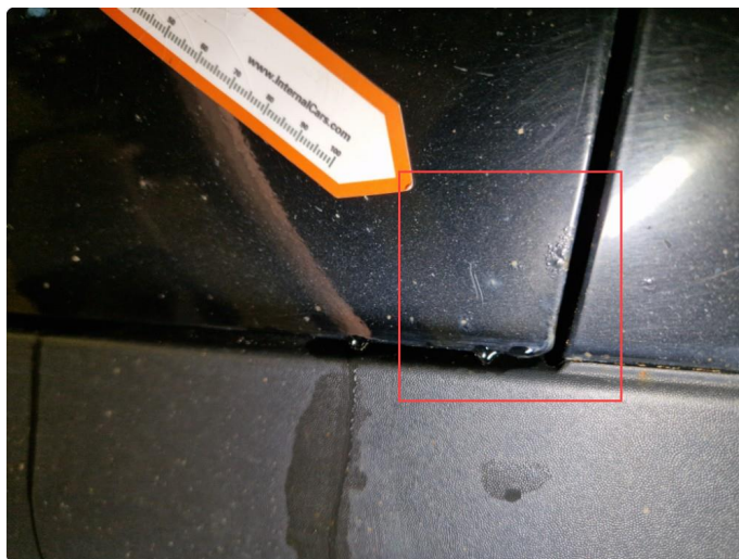
2.6 Rustdannelser + riper / bruksmerker h-framdør.
