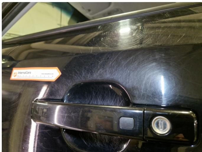
2.3 Rustdannelser + riper / bruksmerker v- framdør.
