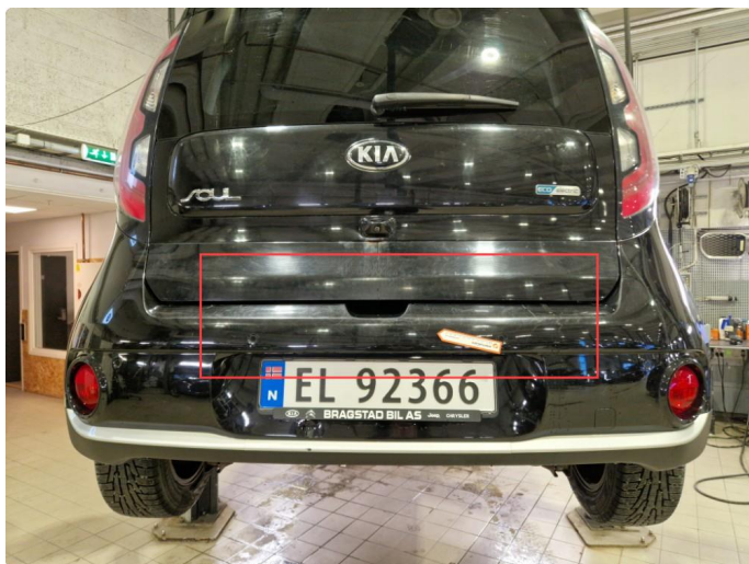
2.16 Bulk med lakkskader / bruksmerker bakfanger.
