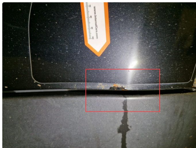
2.4 Rustdannelser nedre del vbakdør.
