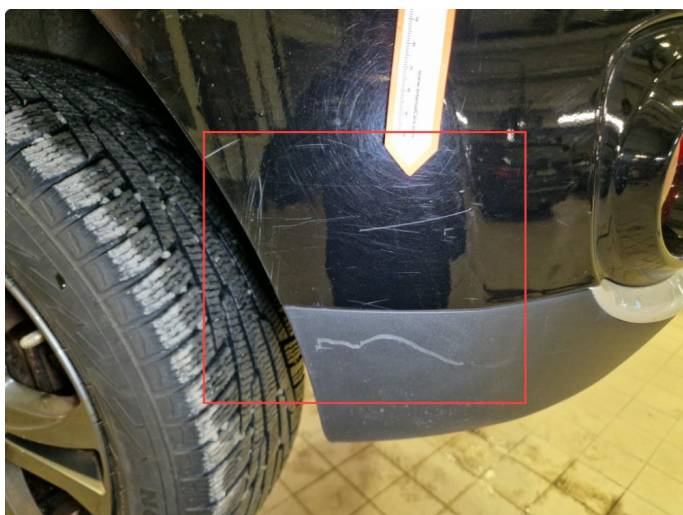
2.16 Bulk med lakkskader / bruksmerker bakfanger.
