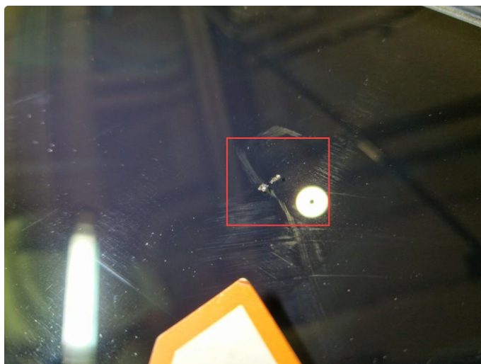
2.17 Flere små steinsprut frontrute, for små til og repareres pr. nå.
