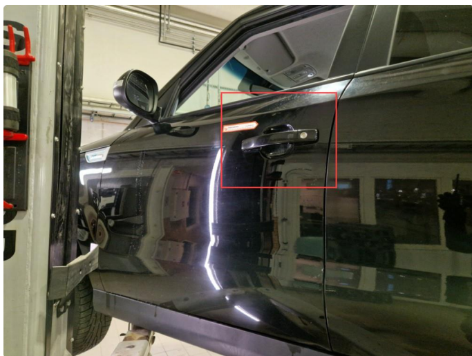
2.3 Rustdannelser + riper / bruksmerker v-framdør.
