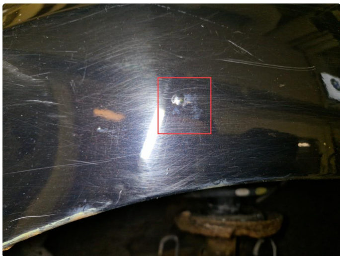
2.8 Stor bulk + rustdannelser v-framskjerm.
