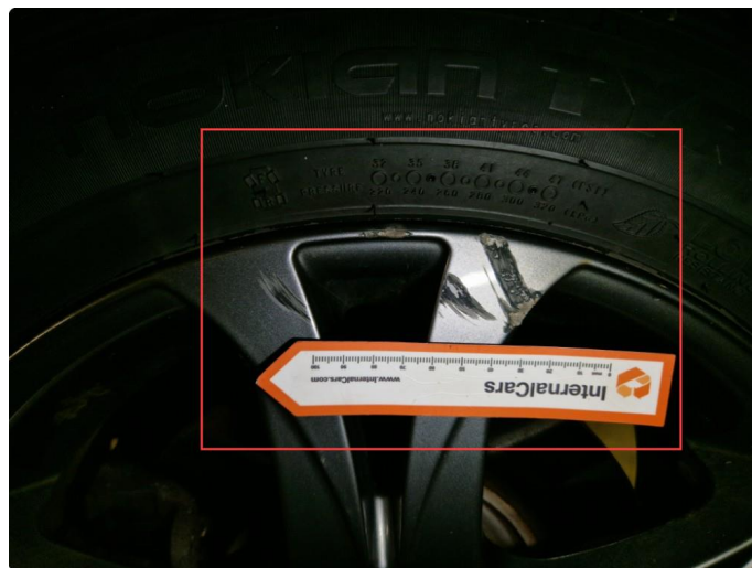
2.12 Bruksmerker vinterfelg v-fram og h-bak.
