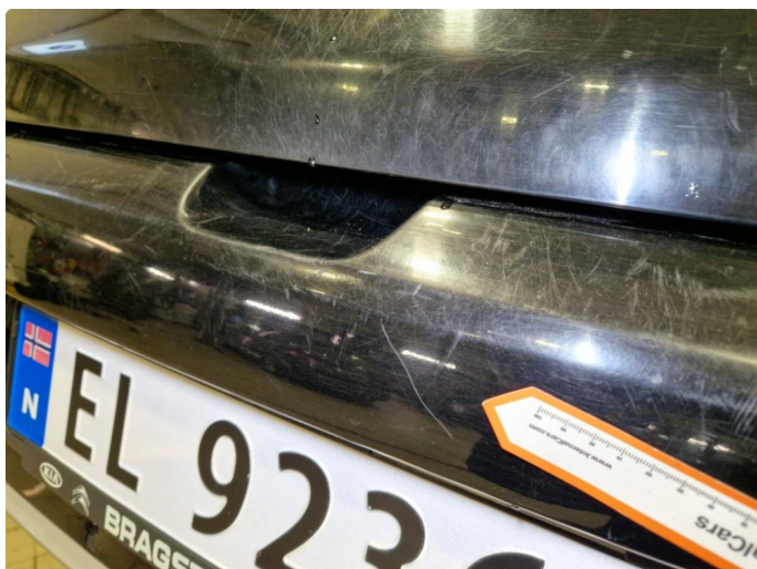
2.16 Bulk med lakkskader / bruksmerker bakfanger.
