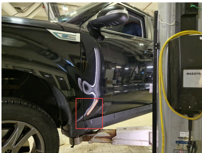
2.3 Rustdannelser + riper / bruksmerker v-framdør.
