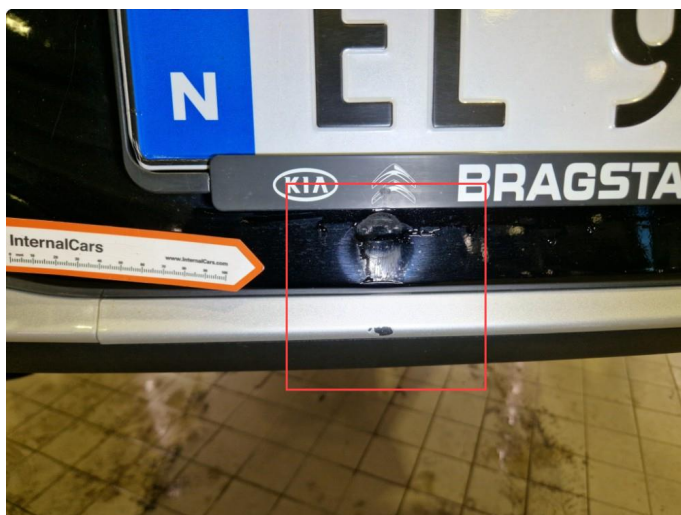
2.16 Bulk med lakkskader / bruksmerker bakfanger.
