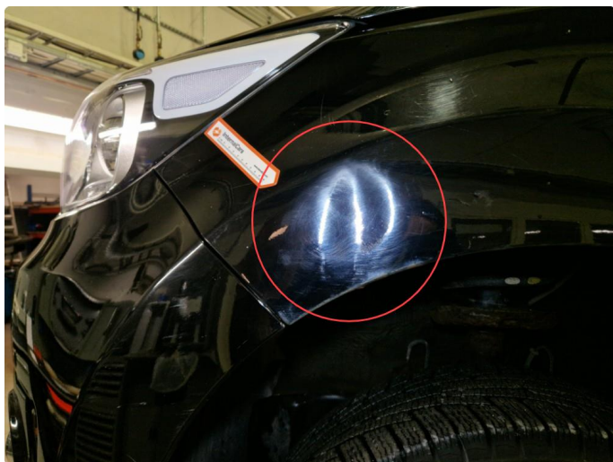
2.8 Stor bulk + rustdannelser v-framskjerm.
