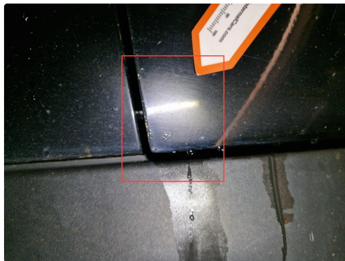
2.3 Rustdannelser + riper / bruksmerker v-framdør.
