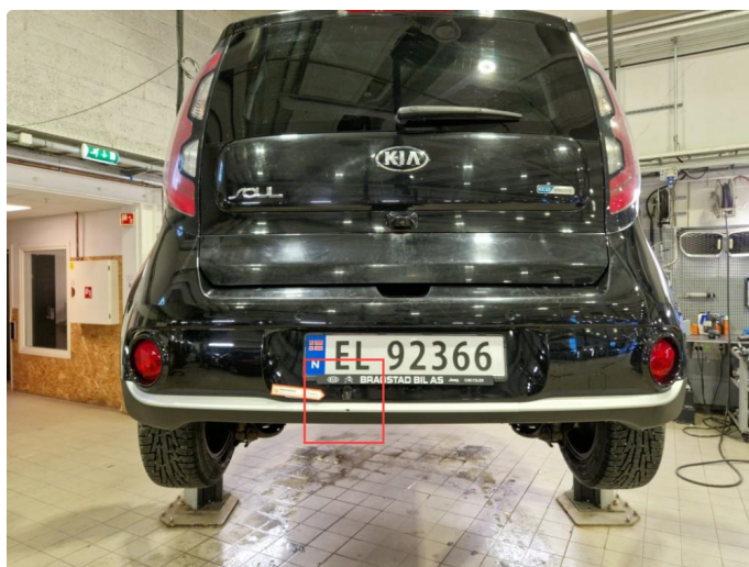
2.16 Bulk med lakkskader / bruksmerker bakfanger.
