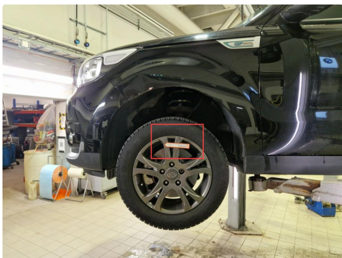
2.12 Bruksmerker vinterfelg v-fram og h-bak.
