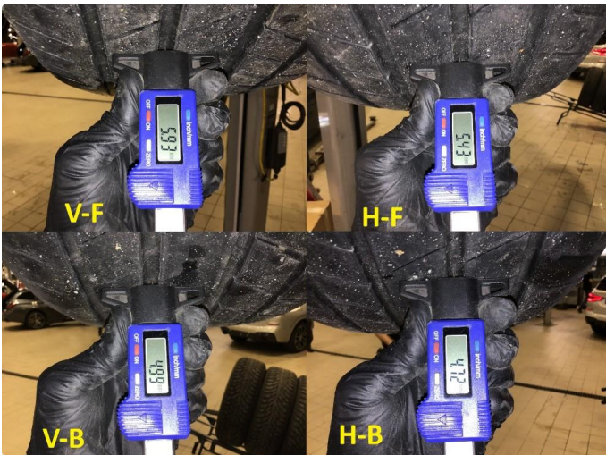
1.1 Mønsterdybde sommerdekk målt ved takst 03.09.2024 44.505km. Nye dekk påsatt etter takst.
