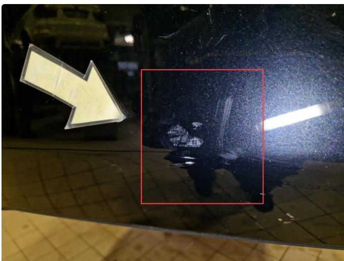
1.3 Noe riper / sår midtre del + hside bakfanger .
