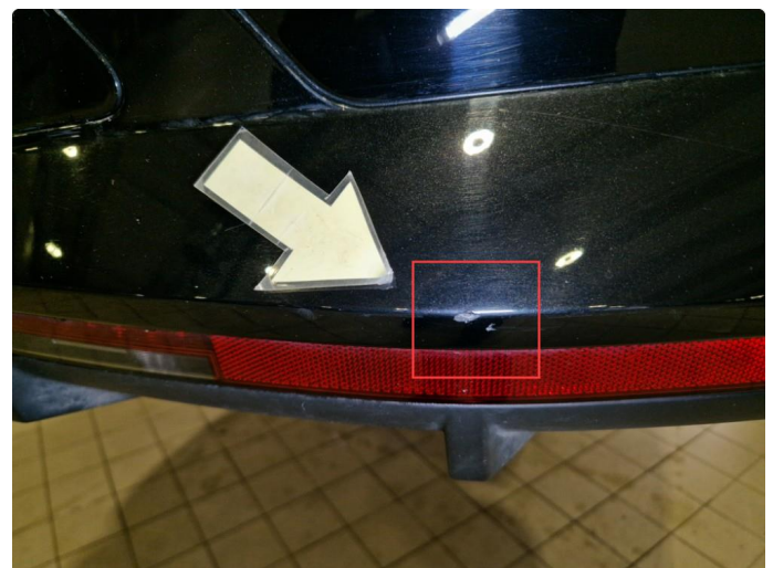
1.3 Noe riper / sår midtre del + hside bakfanger .
