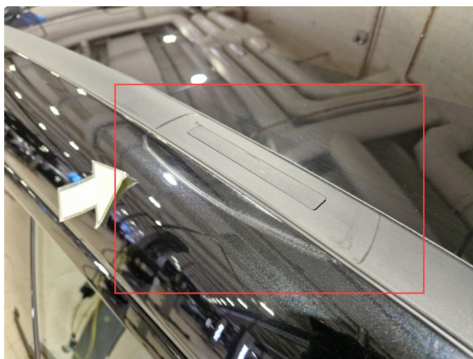
1.4 Noe merker etter lasteholdere fram / bak h+v side .
