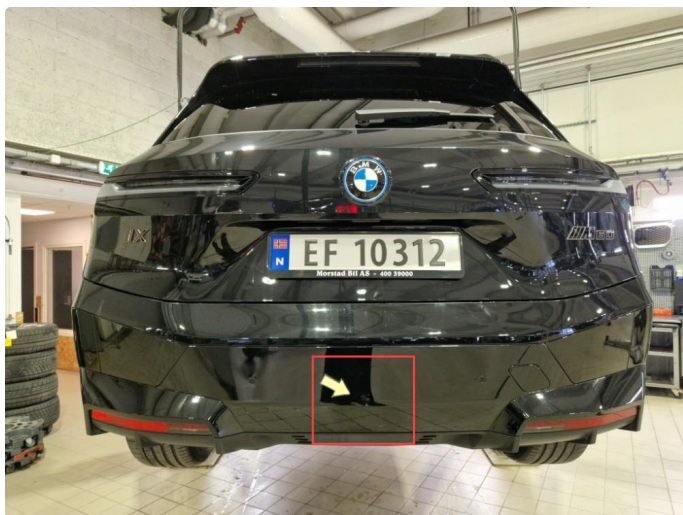
1.3 Noe riper / sår midtre del + hside bakfanger .
