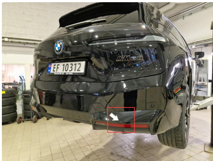
1.3 Noe riper / sår midtre del + hside bakfanger .
