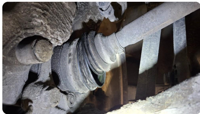
4.1 Drivakselledd defekt Mansjetter defekt, liten ulyd i akselledd
