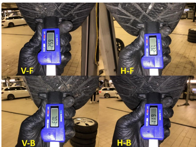
1.5 Mønsterdybde vinterdekk målt ved takst 18.10.2024, 80.805km.
