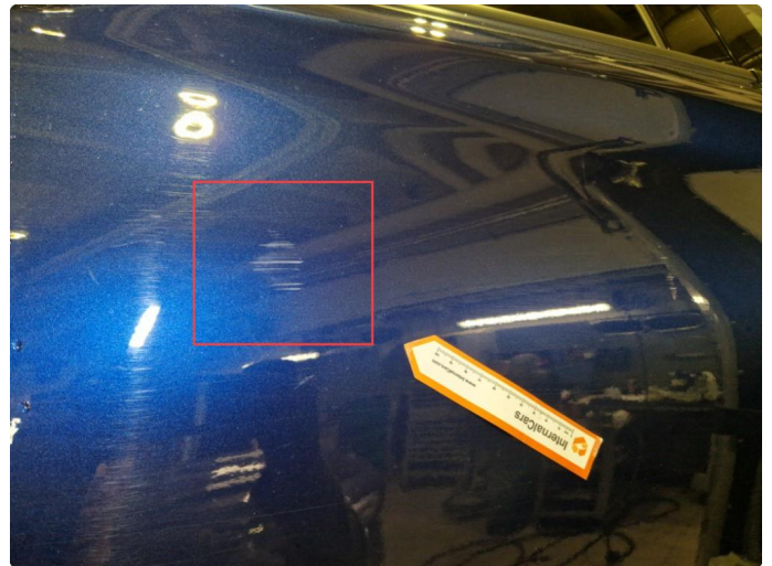
1.2 Noe riper h-bakdør, normal bruksslitasje.
