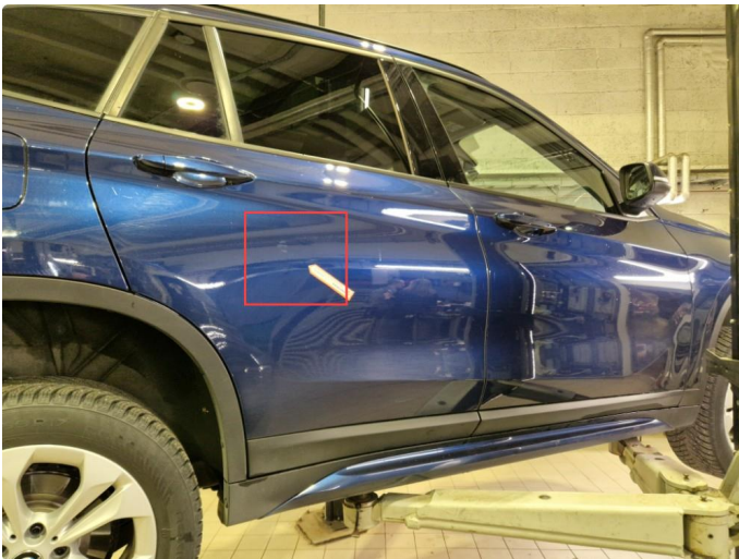
1.2 Noe riper h-bakdør, normal bruksslitasje.
