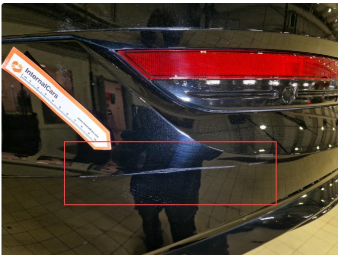
1.3 Noe riper venstre side bakfanger, normal bruksslitasje.
