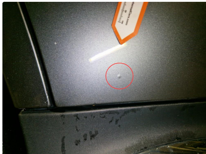
1.1 Liten rustboble nedre del h-bakdør, ytre påvirkning. ( Normal bruksslitasje )
