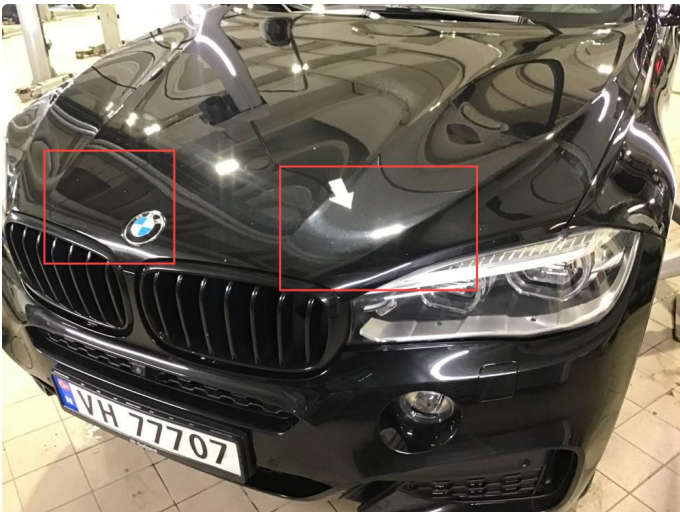
1.1 Noe små steinsprut fremre del panser.
