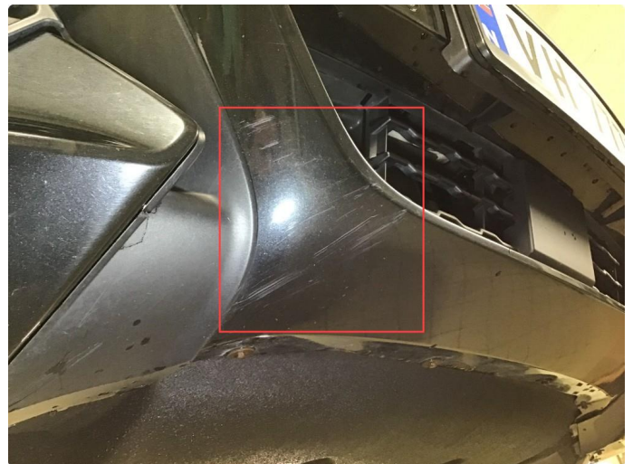
1.3 Skrubbemerker underkant fremfanger, regnes som normal bruksslitasje.
