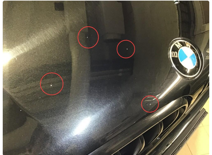
1.1 Noe små steinsprut fremre del panser.
