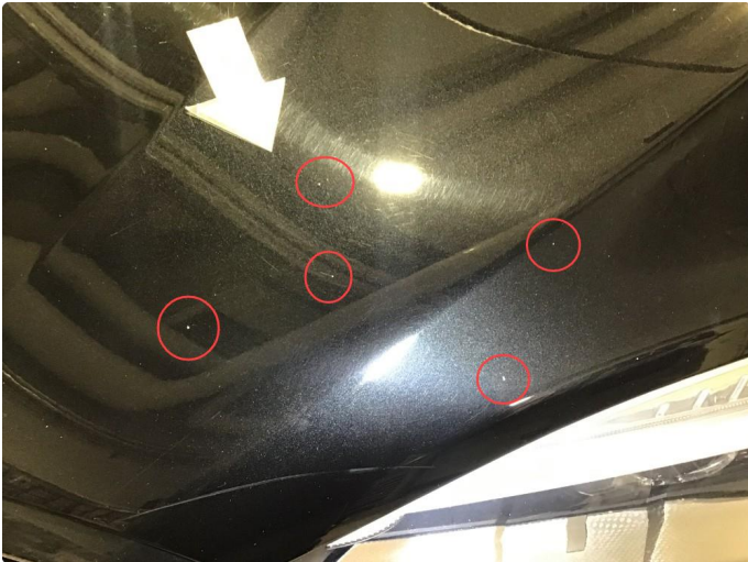
1.1 Noe små steinsprut fremre del panser.
