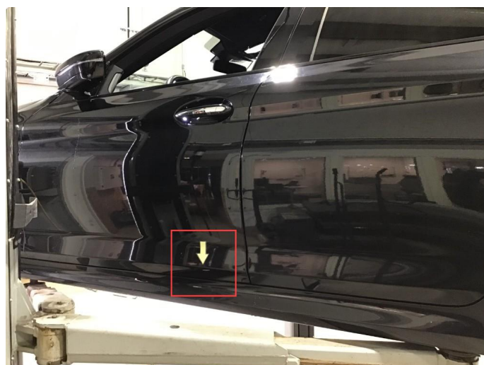
1.2 Ripe på førerdør, flikkes og poleres.
