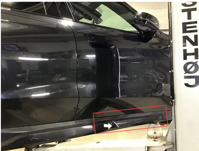
1.3 Noe bruksmerker på kanal, poleres.
