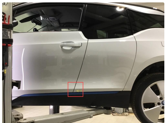
1.2 Lakk sår, flikkes og poleres.
