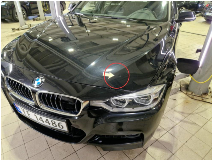
1.1 Steinsprut med fordypning v-side panser, regnes som normal bruksslitasje.
