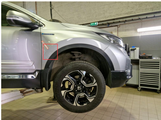
1.1 Liten p-bulk, ikke ut over normal bruksslitasje.
