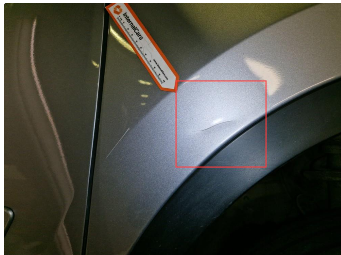
1.1 Liten p-bulk, ikke ut over normal bruksslitasje.
