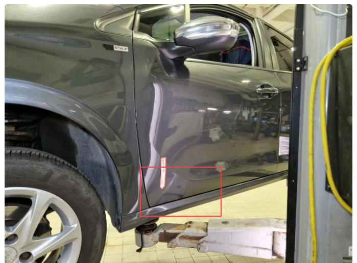
2.2 Flere rustbobler nedre del v-framdør.
