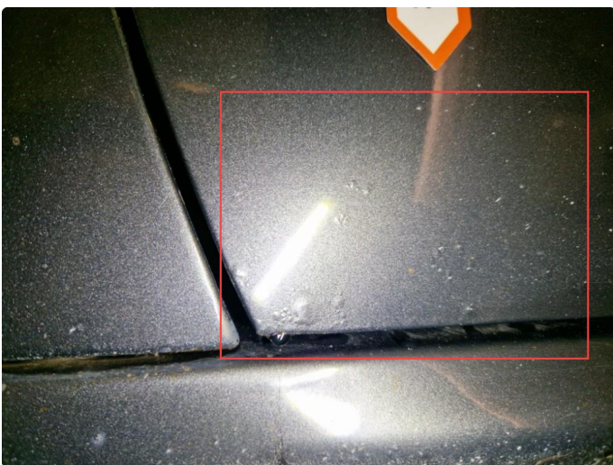
2.2 Flere rustbobler nedre del v-framdør.
