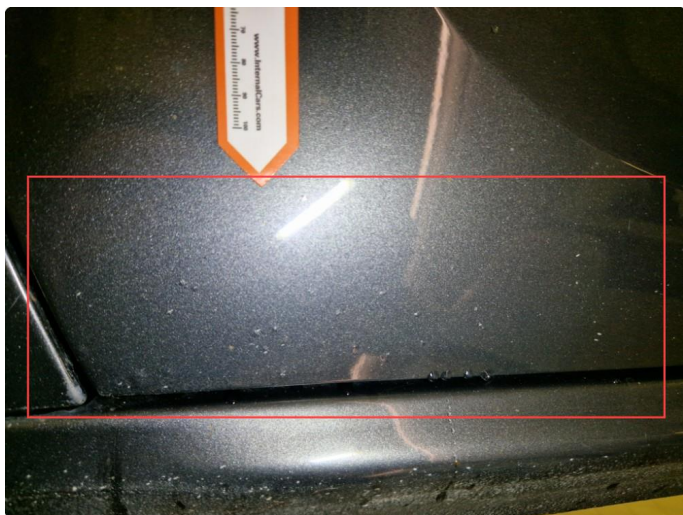
2.2 Flere rustbobler nedre del v-framdør.
