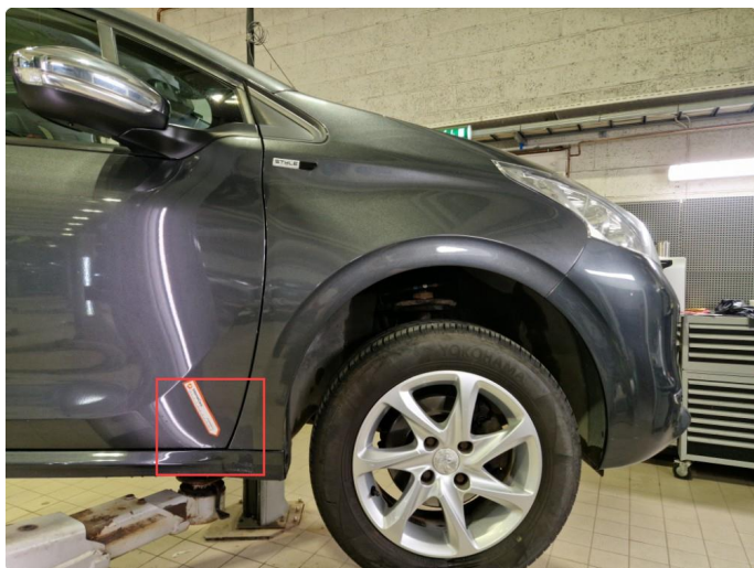
2.4 Rustbobler nedre del h-framdør.
