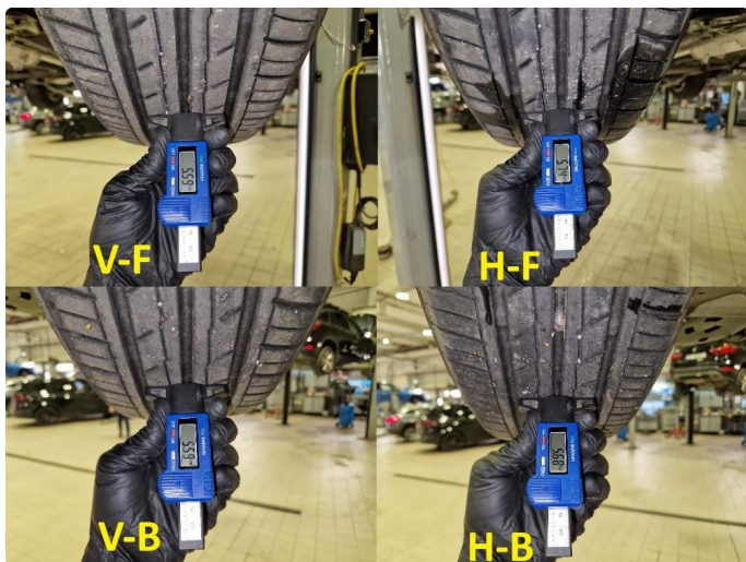
2.9 Dekkdybdemåling sommerdekk, måling utført 05.08.2025 på km : 147779 .
