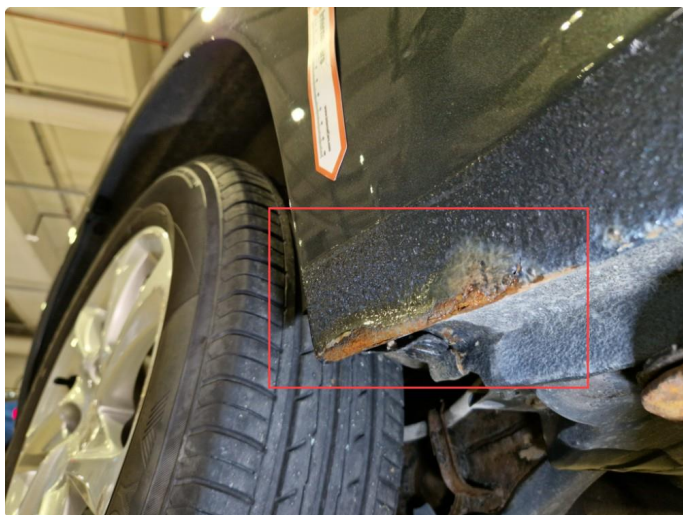
2.14 Noe rust / sluppet bodyshoots nedre bakre del kanal.
