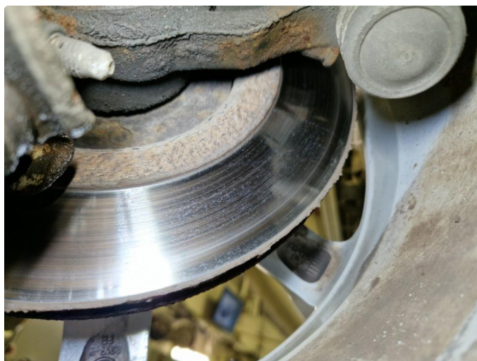
4.1 Slitte / stor slitekant bremseskiver fram , bremseklosser målt til 5mm.
