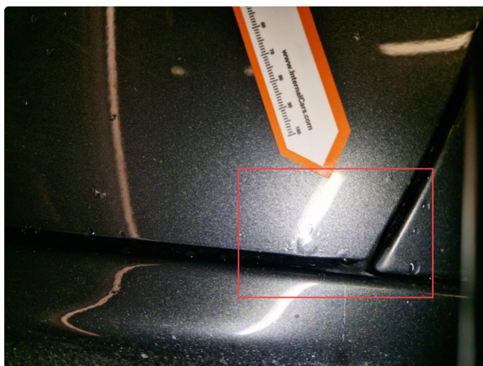
2.4 Rustbobler nedre del h-framdør.
