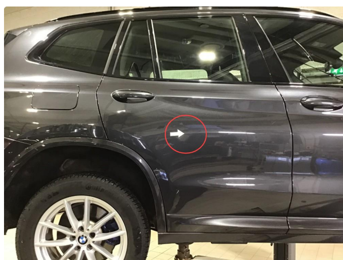
1.2 Liten p-bulk h-bakdør, regnes som normal bruksslitasje.
