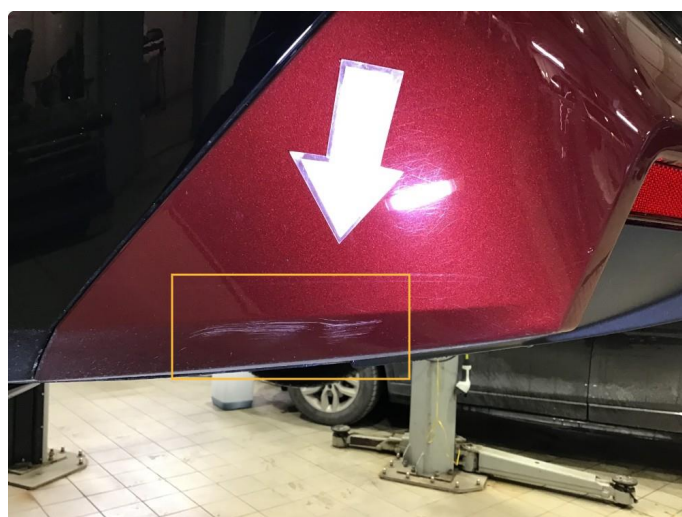
1.2 Noe bruksmerke nedre del venstre side bakfanger.
