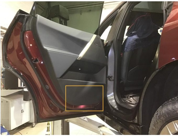
3.1 Noe bruksmerker i dørtrekk, venstre bakdør.
