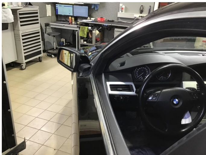
2.13 Elektrisk innfelling speil h+v side virker ikke slik det skal , trolig knekt stag til stopp posisjon.
