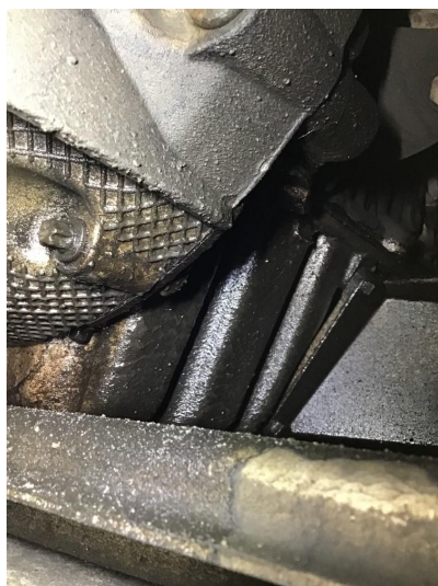
4.1 Oljelekkasje underside motor.
