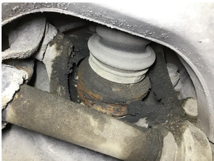
6.2 Lekkasje ytre drivakselmansjett h-bak.
