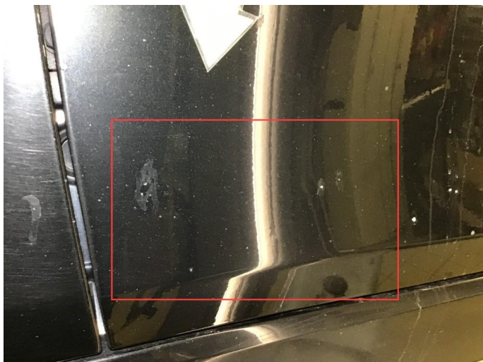
2.4 Lakkskader + p-bulker v- framdør.
