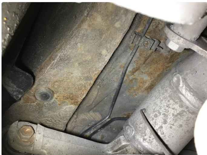
2.2 Rust underside bil ved bakstilling.
