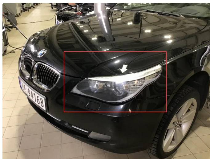
3.1 Dugg/fukt. Fukt v-hovedlykt fram.
