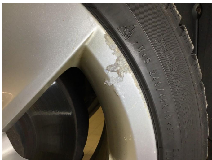
2.15 Korrosjon alle vinterfelger.
