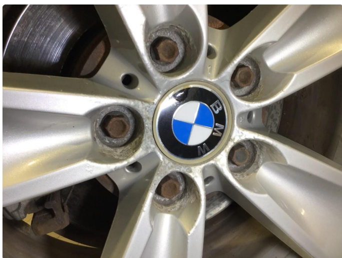
2.15 Korrosjon alle vinterfelger.
