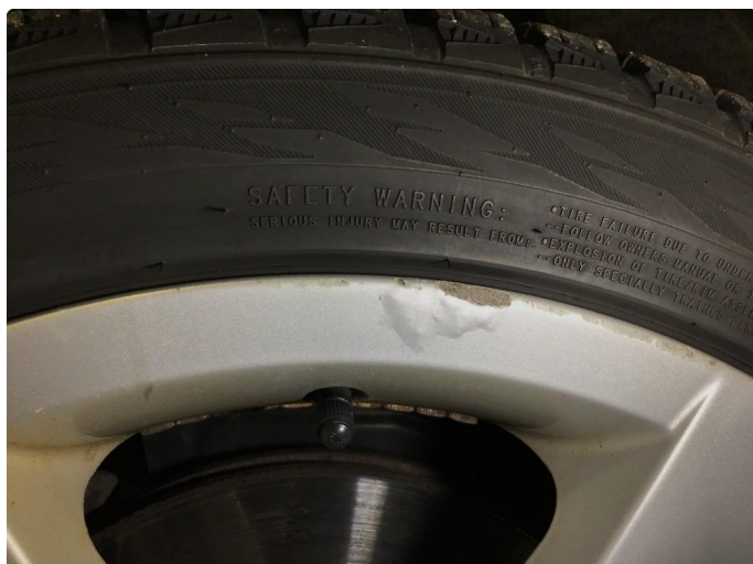
2.15 Korrosjon alle vinterfelger.
