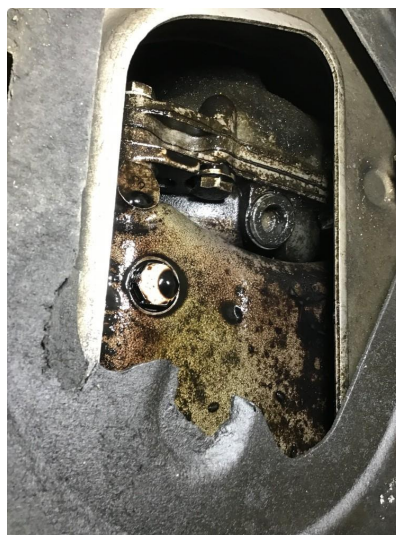
4.1 Oljelekkasje underside motor.
