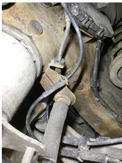
2.2 Rust underside bil ved bakstilling.
