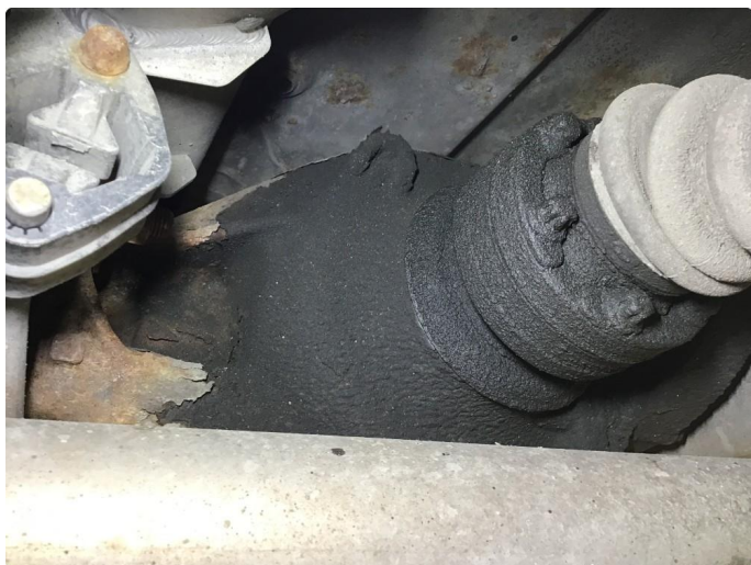
6.1 Lekkasje bakre differensial v-side utgående aksel.
