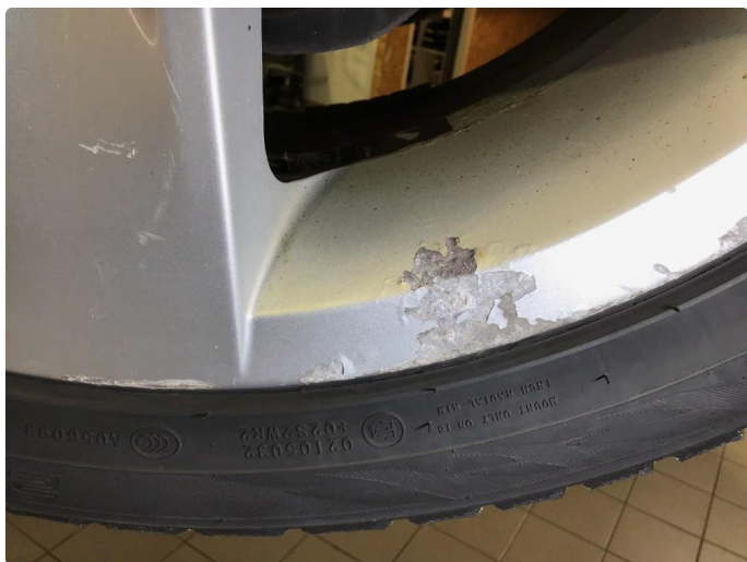
2.15 Korrosjon alle vinterfelger.
