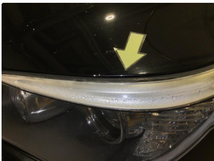
3.1 Dugg/fukt. Fukt v-hovedlykt fram.
