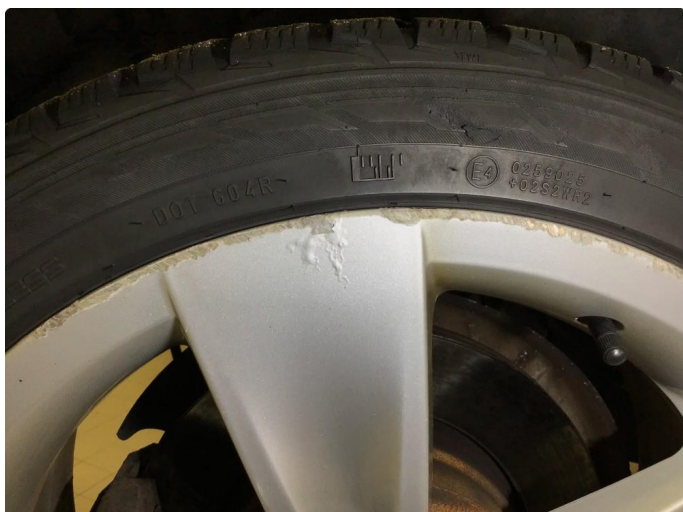
2.15 Korrosjon alle vinterfelger.
