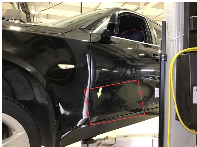
2.4 Lakkskader + p-bulker v- framdør.
