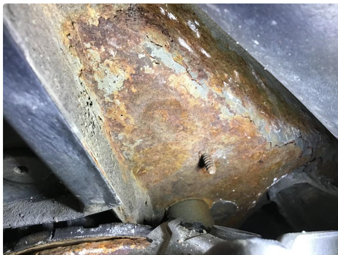
2.2 Rust underside bil ved bakstilling.
