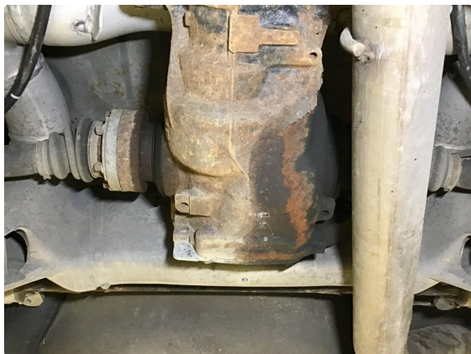
6.1 Lekkasje bakre differensial v-side utgående aksel.
