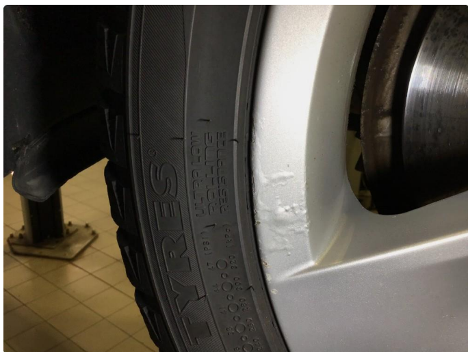
2.15 Korrosjon alle vinterfelger.
