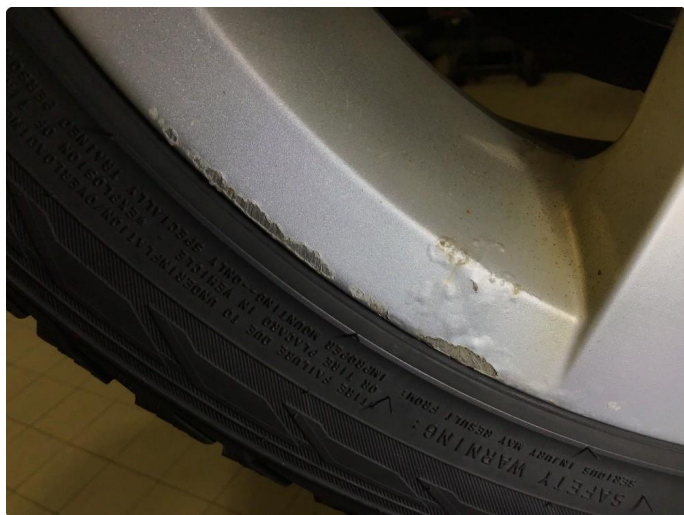
2.15 Korrosjon alle vinterfelger.
