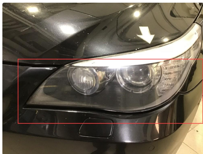
3.1 Dugg/fukt. Fukt v-hovedlykt fram.
