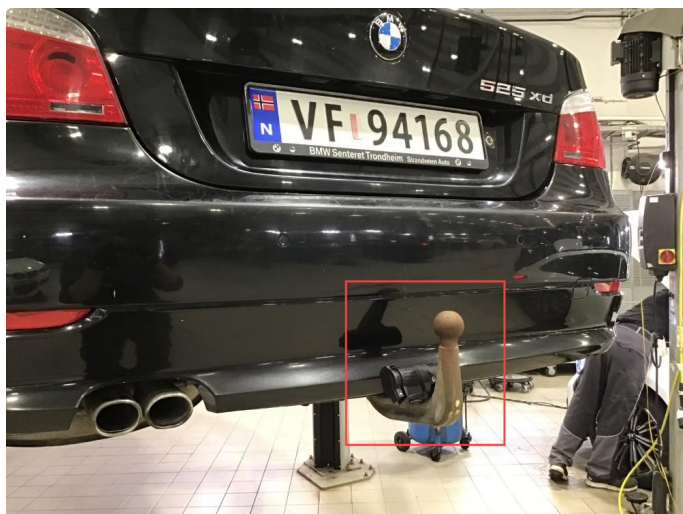
2.14 Avtagbart/innsvingbart tilhengerkule skadet/funksjonsfeil. Elektrisk innfelling hengerfeste virker ikke.
