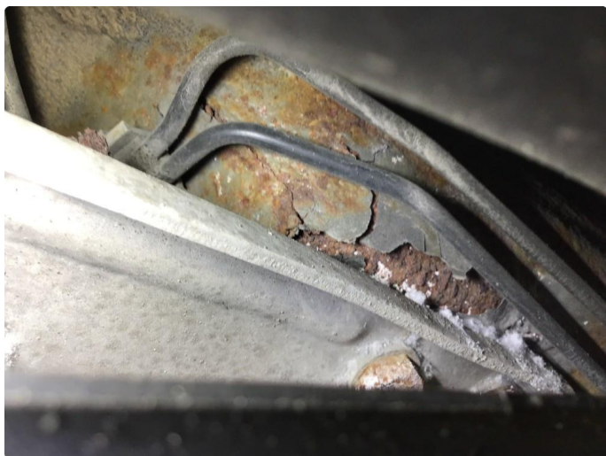
2.2 Rust underside bil ved bakstilling.
