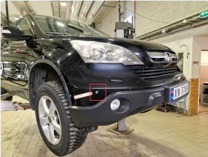
1.1 Korrosjon parksensor h-fram.
