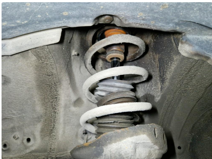
5.1 Sprukket støtdempermansjett h+v side fram.
