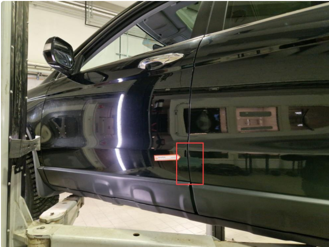
2.1 Lakksår / bruksmerker bakre del v-framdør.
