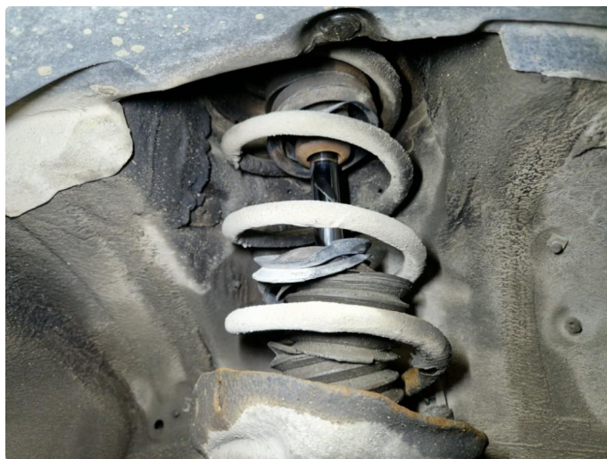
5.1 Sprukket støtdempermansjett h+v side fram.
