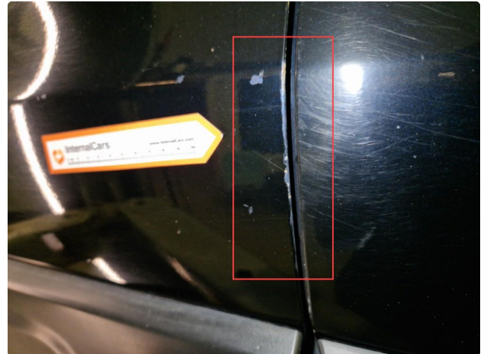
2.1 Lakksår / bruksmerker bakre del v-framdør.
