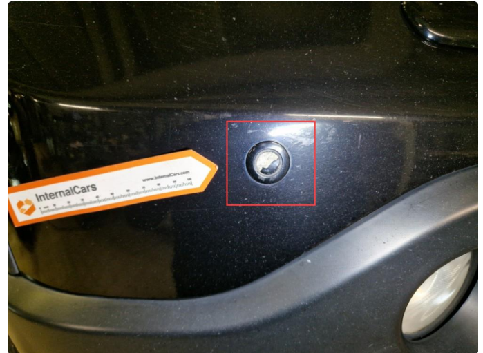
1.1 Korrosjon parksensor h-fram.
