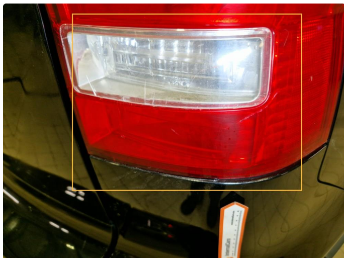
3.3 Sprekkdannelser lykteglass h-baklykt.
