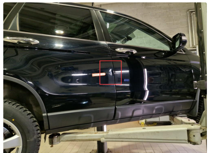
2.2 Rust + bulk h-bakdør.
