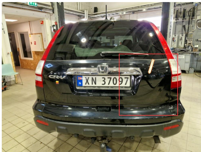
2.3 Bakluke er trolig opplakkert da det vises flere støvkorn i lakk og lakksig.
