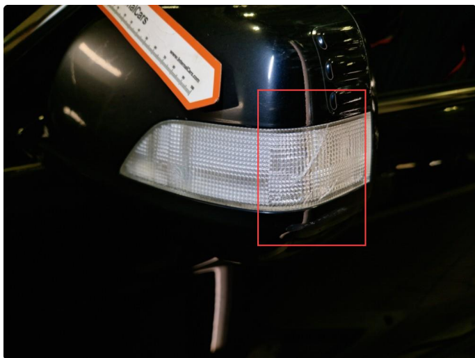
2.5 Sprekkdannelser blinklykt i speil v-side.
