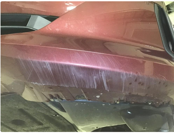
1.5 Skrubbermerker underkant fremfanger, normal bruksslitasje.
