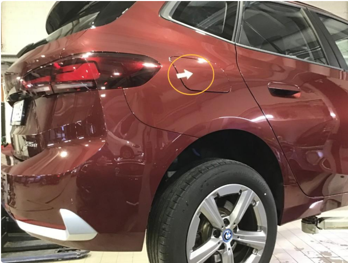
1.1 Liten p-bulk h-bakskjerm, regnes som normal bruksslitasje.
