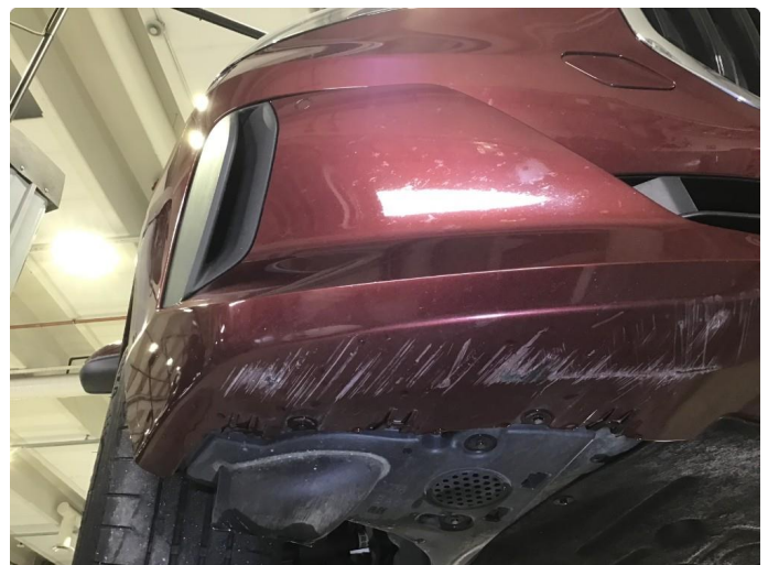
1.5 Skrubbermerker underkant fremfanger, normal bruksslitasje.
