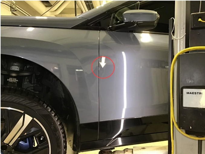
1.1 Liten p-bulk fremre del v-framdør ( Normal bruksslitasje )
