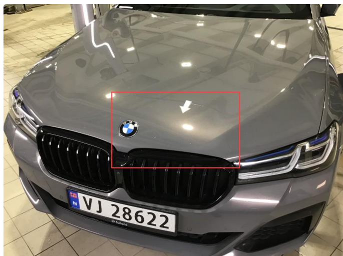
1.1 Noe steinsprut panser, regnes som normal bruksslitasje.
