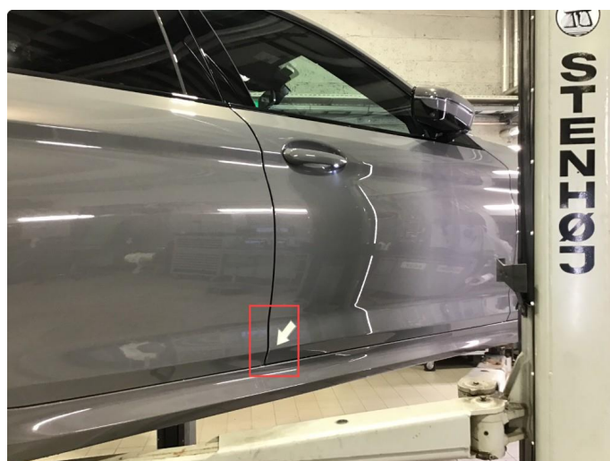
1.2 Noe sår bakre nedre del h+v framdør.
