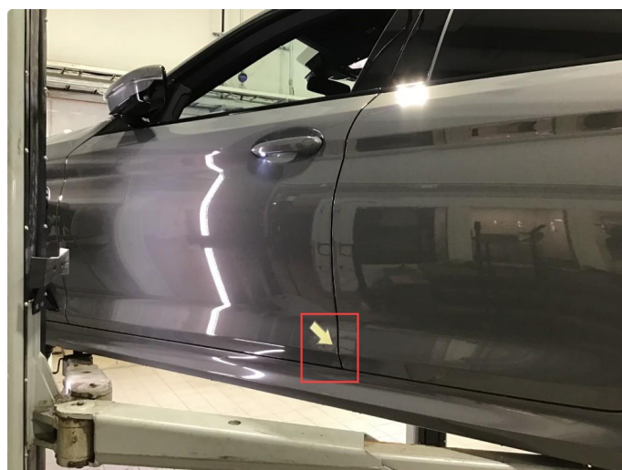
1.2 Noe sår bakre nedre del h+v framdør.
