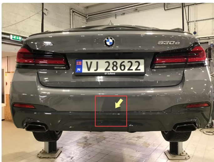
1.4 Noe sår midtre del bakfanger, poleres.
