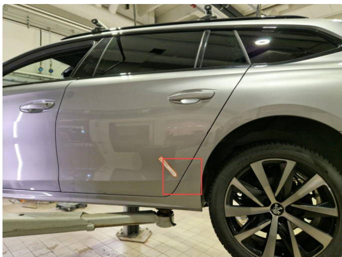
1.2 Lite lakksår med overflaterust, venstre bakdør.
