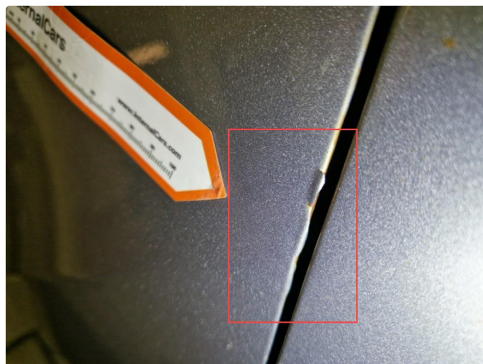
1.2 Lite lakksår med overflaterust, venstre bakdør.
