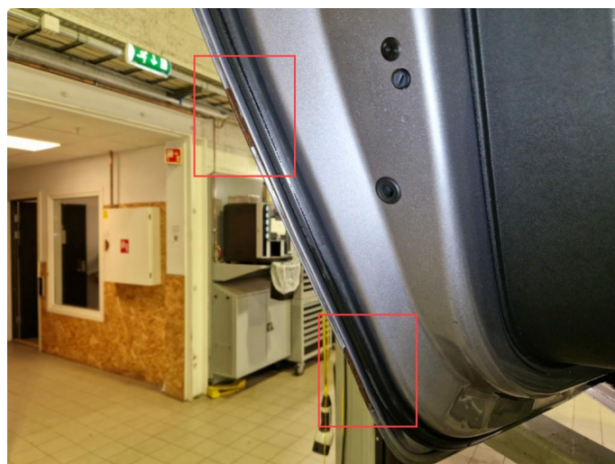
1.2 Lite lakksår med overflaterust, venstre bakdør.
