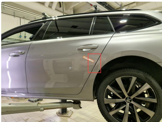
1.2 Lite lakksår med overflaterust, venstre bakdør.
