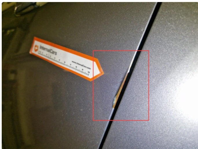
1.2 Lite lakksår med overflaterust, venstre bakdør.
