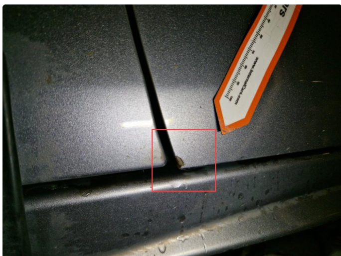
1.1 Lakksår nedre fremre del vframdør + liten p-bulk ( Poleres).
