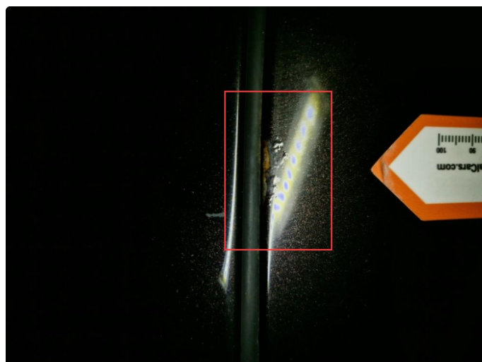
1.2 Noe rustbobler nedre bakre del h yre framd r, normal bruksslitasje iht. km og alder.
