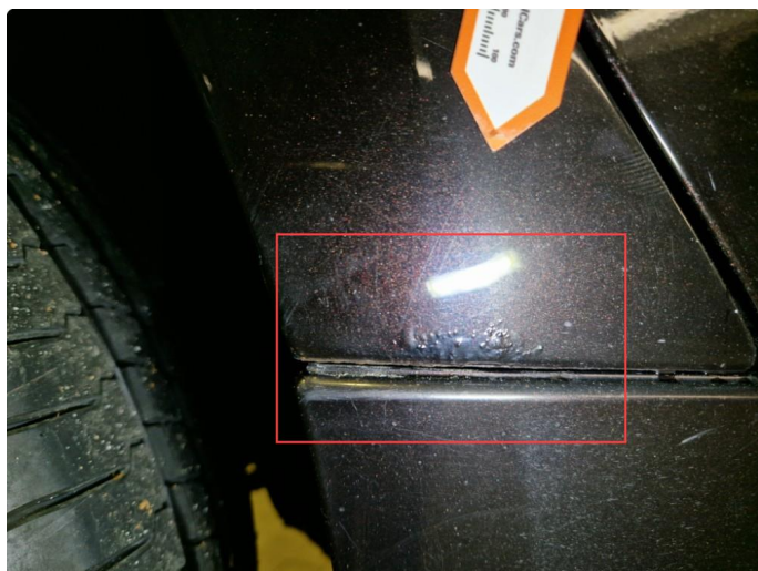
1.4 Noen rustbobler høyre baksjerm, normal bruksslitasje iht. km og alder.
