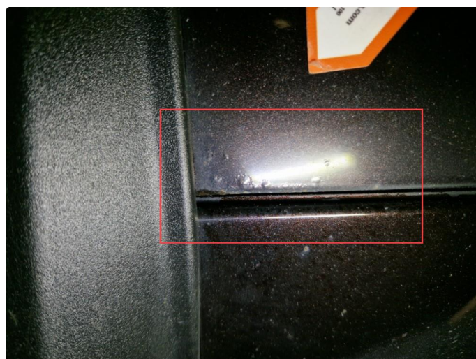
1.3 Noen rustbobler venstre framskjerm, normal bruksslitasje iht. km og alder.
