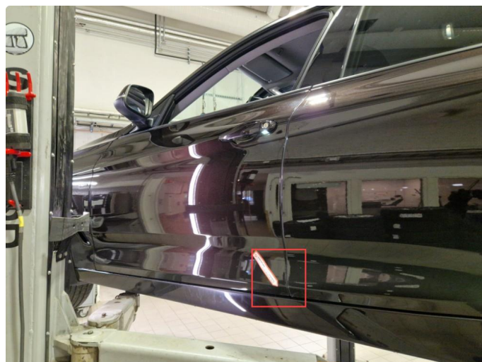
1.1 Noe rustbobler nedre bakre del v enstre framd r, normal bruksslitasje iht. km og alder.
