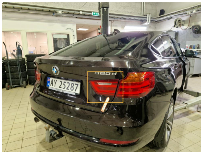
2.1 Små sprekkdannelser lykteglass indre baklykt h+v side.
