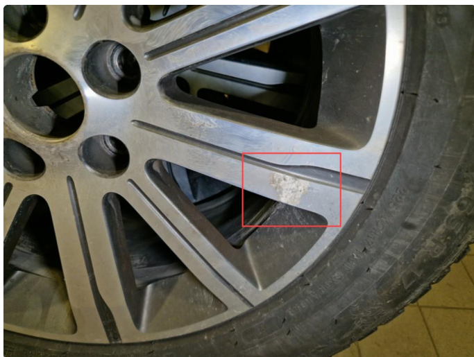
1.3 Noe korrosjon alle vinterfelger, normalt iht. km og alder.
