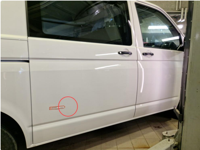
1.1 2 Stk små p-bulker h-bakdør ( Normal bruksslitasje)
