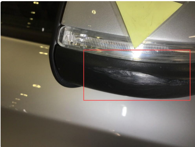
1.2 Noe riper nedre del speilhus h-side.
