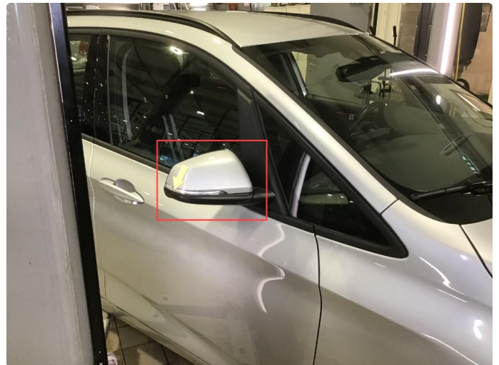
1.2 Noe riper nedre del speilhus h-side.
