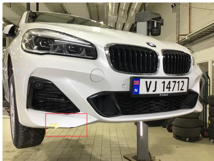
1.3 Skrubbskader underkant frontfanger , normal bruksslitasje .
