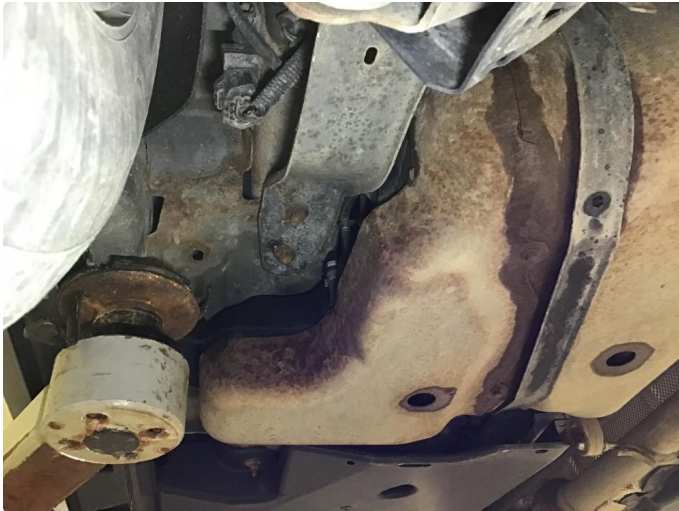
1.1 Noe rust ved bakstilling + deksel rundt drivstofftank.
