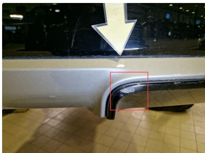
1.4 Noe riper / sår bakfanger ( Poleres / Flekkes )
