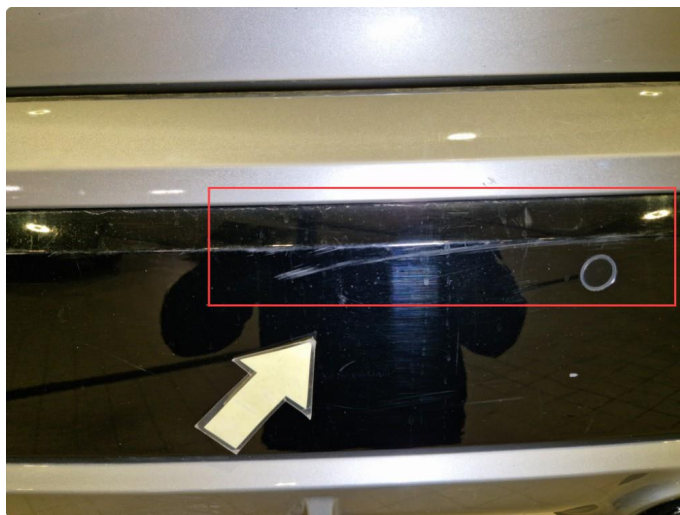
1.4 Noe riper / sår bakfanger ( Poleres / Flekkes )
