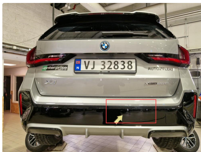
1.4 Noe riper / sår bakfanger ( Poleres / Flekkes )
