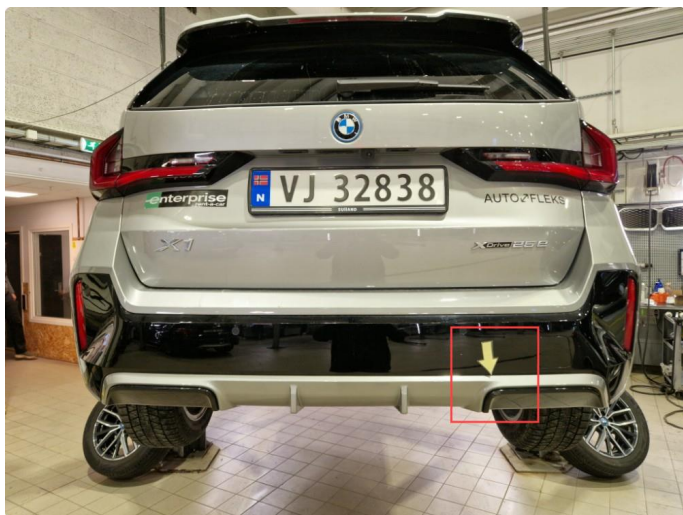
1.4 Noe riper / sår bakfanger ( Poleres / Flekkes )
