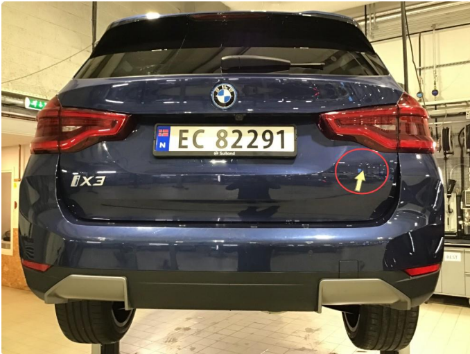
1.1 Liten p-bulk h-side bakluke, regnes som normal bruksslitasje.
