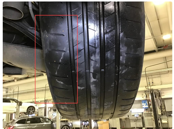
1.4 Noe tegn til skjev slittasje på sommerdekk.
