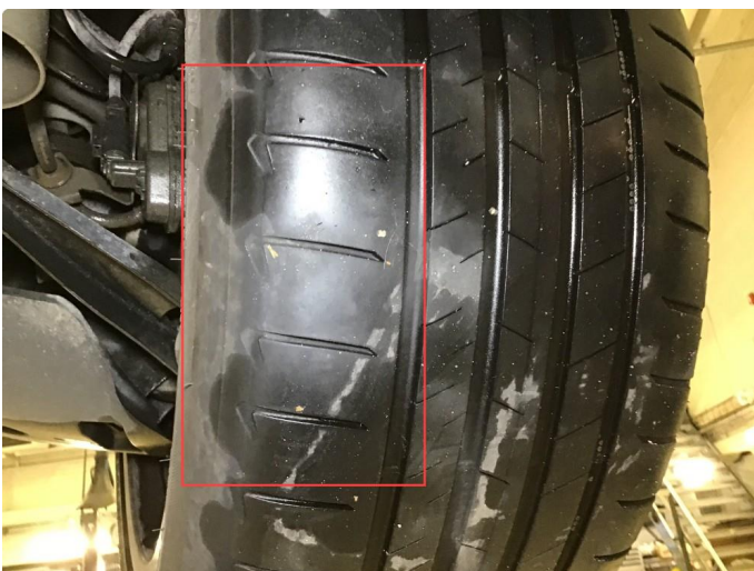
1.4 Noe tegn til skjev slittasje på sommerdekk.
