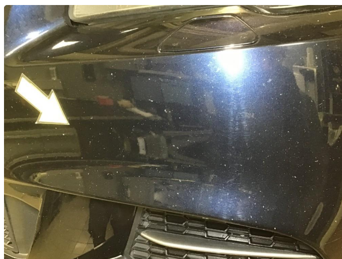
1.3 Noe steinsprut på frontfanger.
