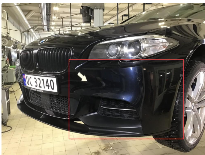
1.3 Noe steinsprut på frontfanger.
