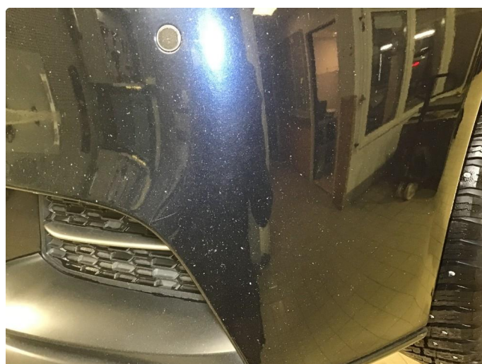
1.3 Noe steinsprut på frontfanger.
