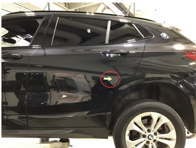
1.2 Liten p-bulk v-bakdør, regnes som normal bruksslitasje.
