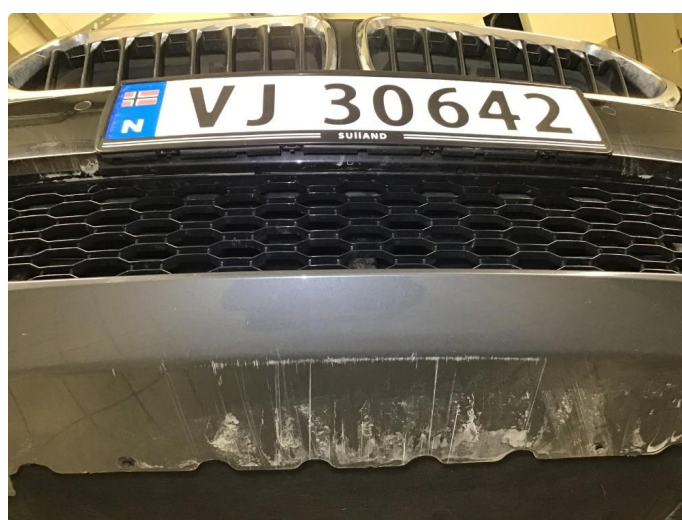
1.6 Noen skrubbermerker underkant fremfanger, regnes som normal bruksslitasje.
