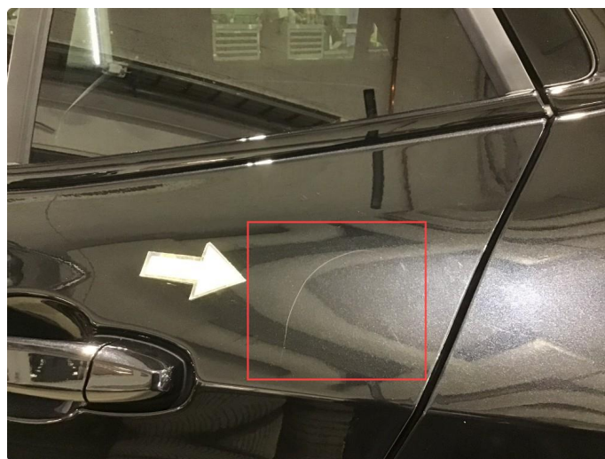
1.2 Liten p-bulk v-bakdør, regnes som normal bruksslitasje.
