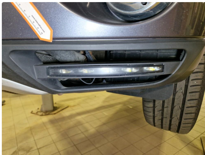
2.12 Mangler deksel ved markeringslys v-side frontfanger.
