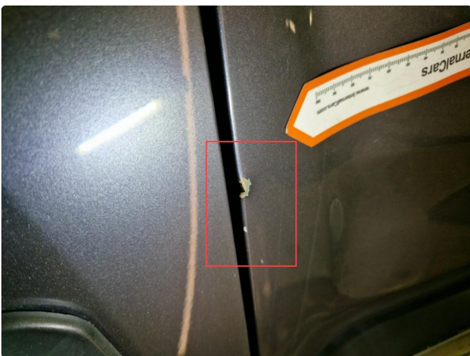
2.3 Bulker / skader fremre del v-framdør.
