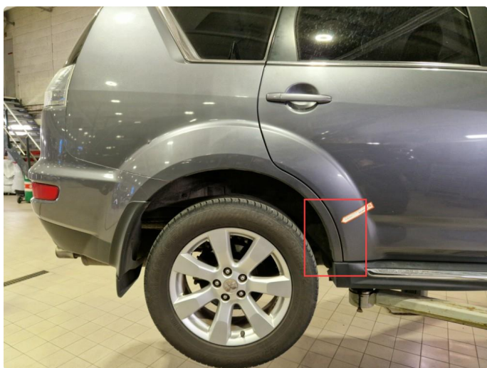
2.8 Rustdannelser h-bakskjerm mot bakluke + bulk.
