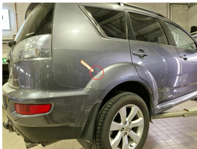
2.8 Rustdannelser h-bakskjerm mot bakluke + bulk.
