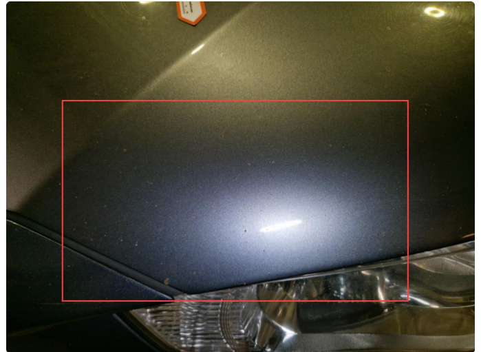
2.2 Flere steinsprut fremre del panser.
