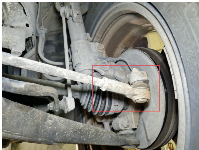
4.1 Stor slakke ytre styreledd h-side.
