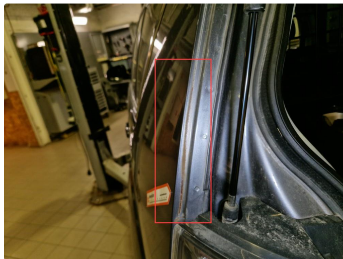
2.7 Rustdannelse v-bakskjerm mot bakluke.
