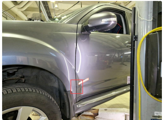
2.3 Bulker / skader fremre del v-framdør.
