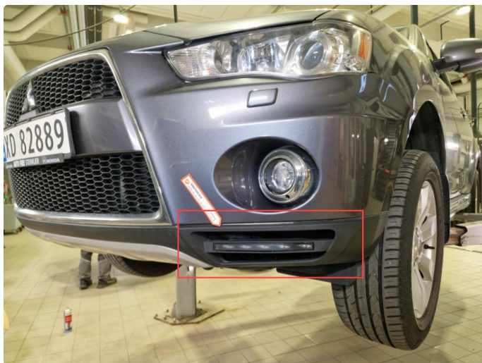
2.12 Mangler deksel ved markeringslys v-side frontfanger.
