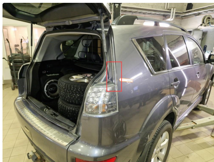
2.8 Rustdannelse h-bakskjerm mot bakluke + bulk.
