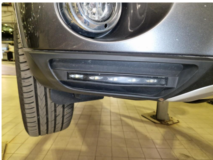
2.12 Mangler deksel ved markeringslys v-side frontfanger.
