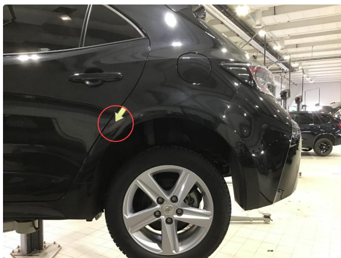
1.2 Liten p-bulk v-bakskjerm, regnes som normal bruksslitasje.
