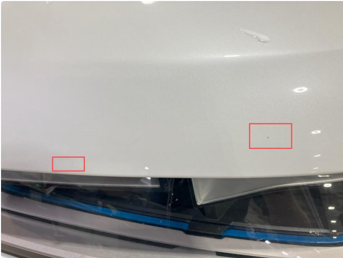
1.1 Noe steinsprut på panser, regnes som normal bruksslitasje.
