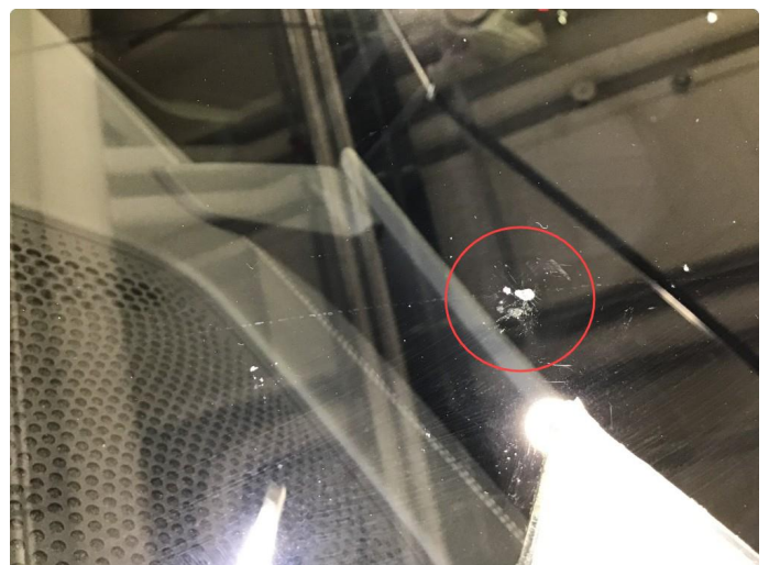
1.4 Steinsprut frontrute , er reparert tidligere.
