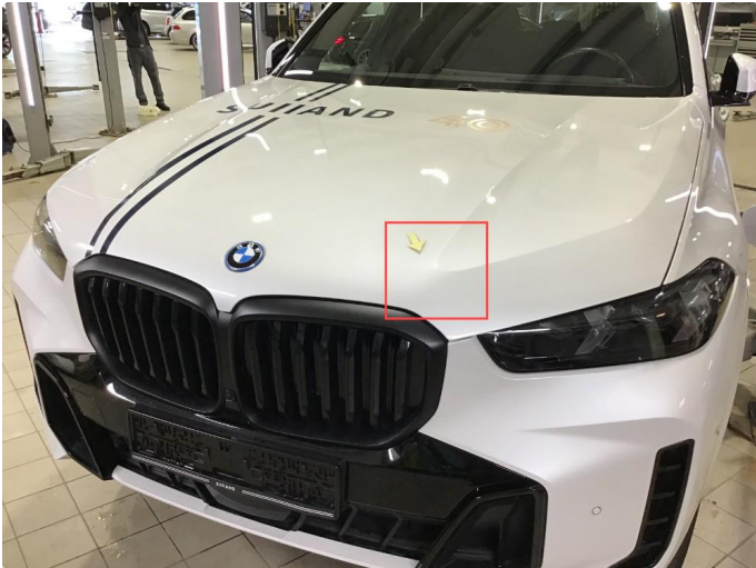
1.1 Noen steinsprut panser, normal bruksslitasje .
