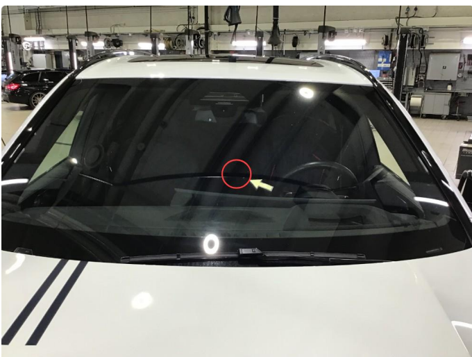
1.4 Steinsprut frontrute , er reparert tidligere.
