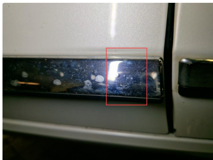
1.1 Noe korrosjon nedre chromelist alle dører, normal bruksslitasje iht. km og alder.
