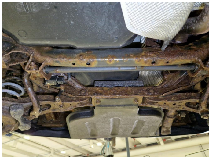
2.1 Rustdannelser underside bil.
