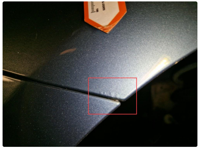
2.4 Rust h+v framskjerm og h+v bakskjerm.
