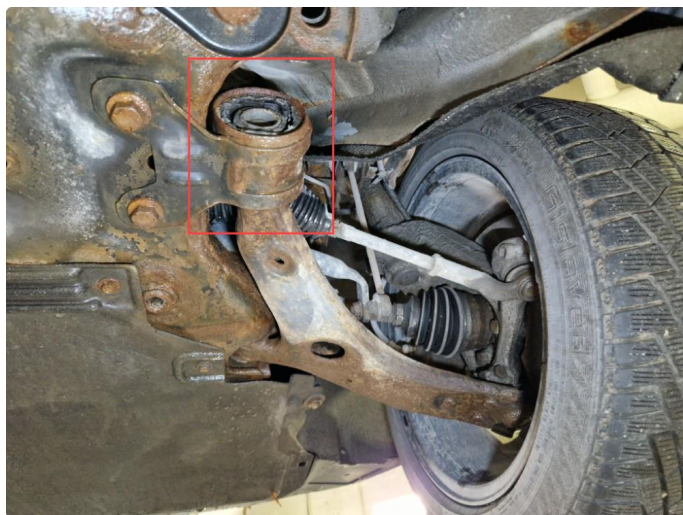
5.2 Slitt bakre bæreamsforing h-fram.
