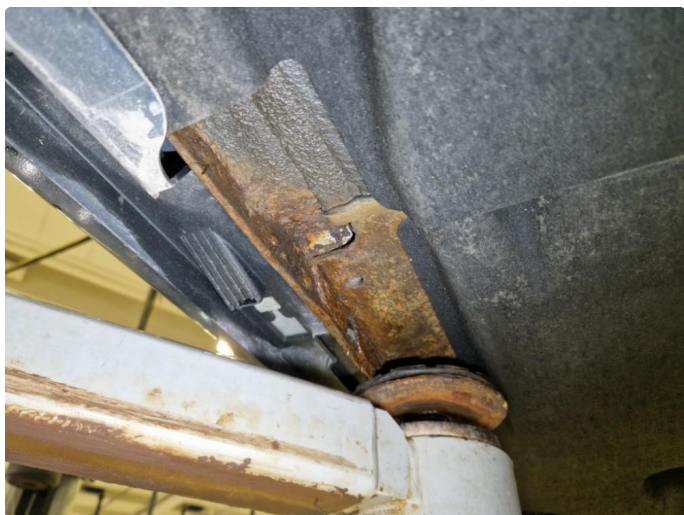
2.1 Rustdannelser underside bil.
