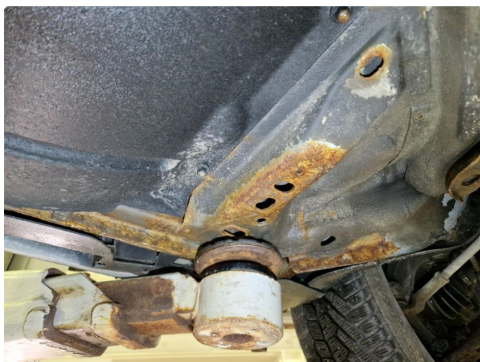
2.1 Rustdannelser underside bil.
