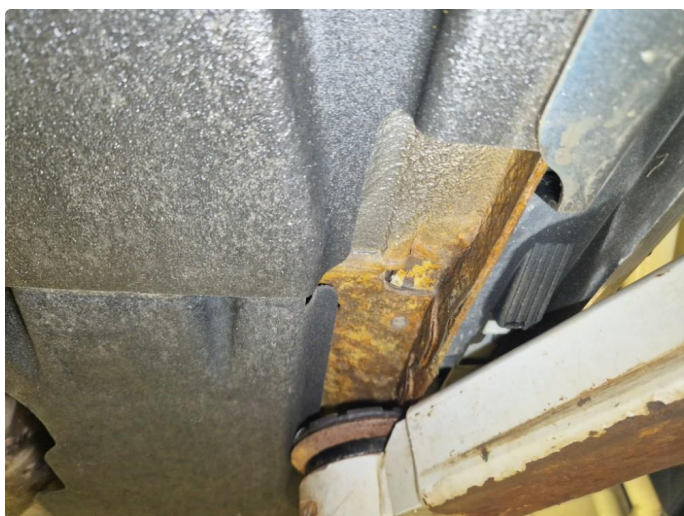
2.1 Rustdannelser underside bil.
