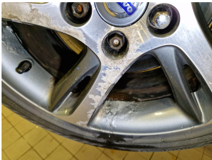
2.6 Korrosjon alle vinterfelger.
