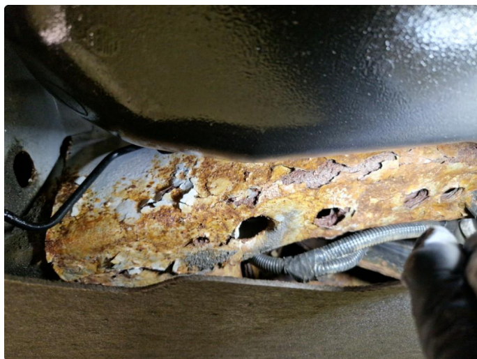
2.1 Rustdannelser underside bil.
