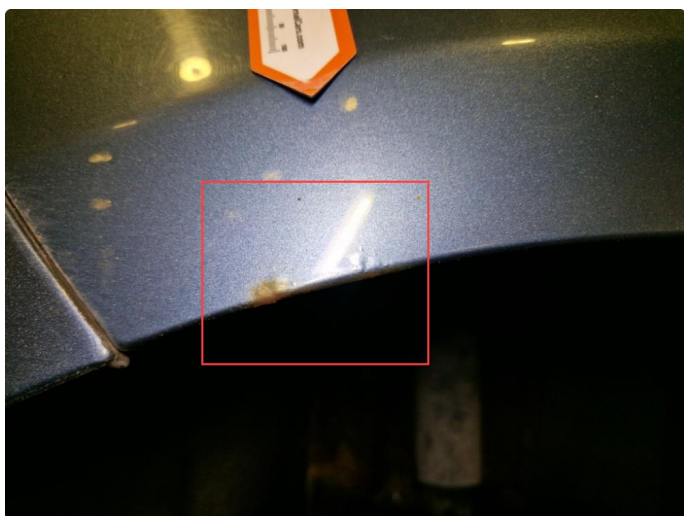
2.4 Rust h+v framskjerm og h+v bakskjerm.
