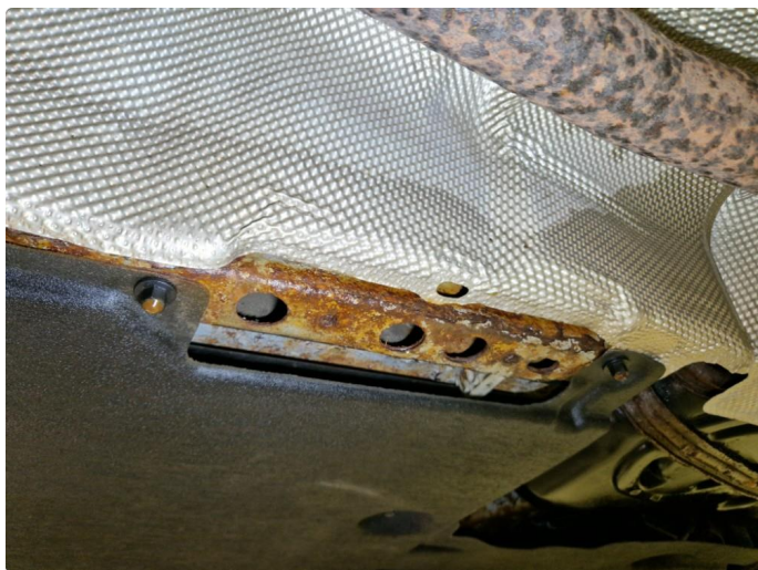
2.1 Rustdannelser underside bil.
