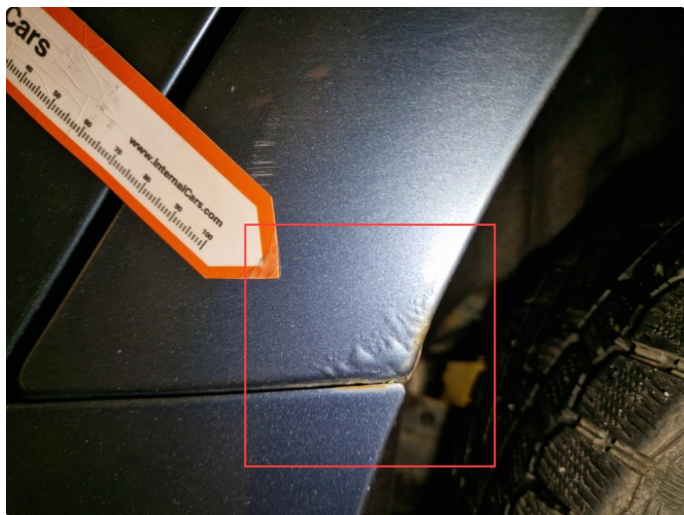
2.4 Rust h+v framskjerm og h+v bakskjerm.
