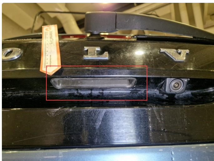
2.3 Mikrobryter for åpning av bakluke virker ikke.
