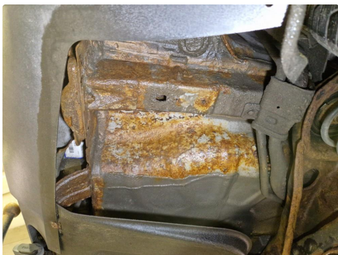
2.1 Rustdannelser underside bil.
