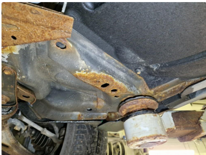
2.1 Rustdannelser underside bil.
