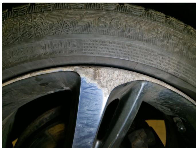
2.6 Korrosjon alle vinterfelger.
