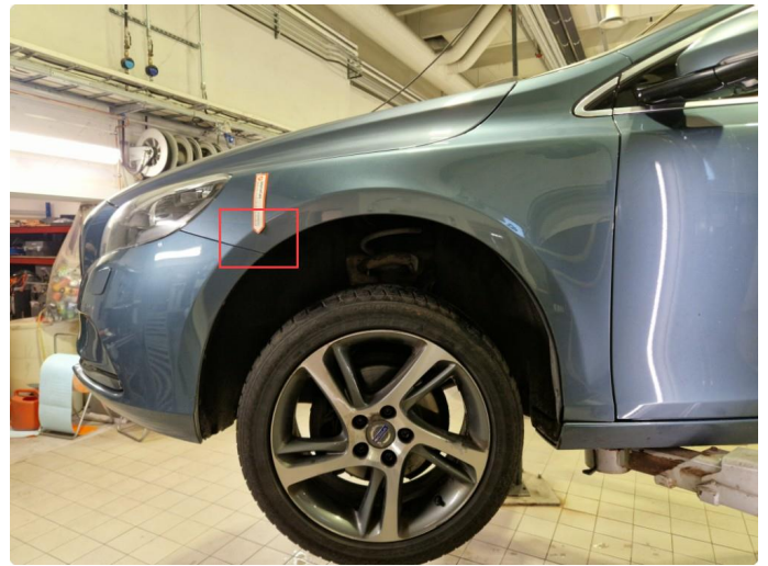
2.4 Rust h+v framskjerm og h+v bakskjerm.
