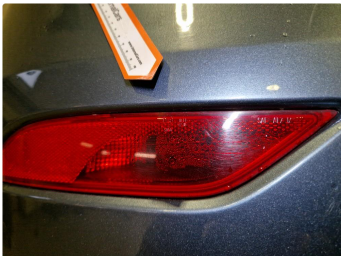
3.2 Defekt / sprukket glass
