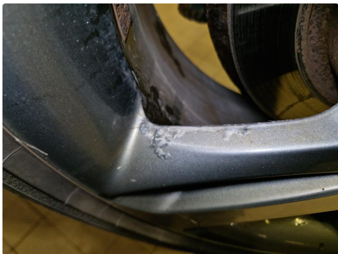
2.6 Korrosjon alle vinterfelger.
